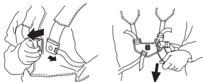
Certains harnais sont également équipés d'une plaque pectorale à libération rapide au niveau du crochet de suspension. Relever le levier de verrouillage droit pour libérer la machine du harnais.
