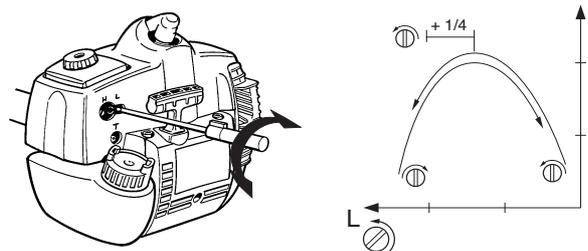
**REMARQUE!** Si l'équipement de coupe tourne au ralenti, tourner le pointeau de ralenti T dans le sens contraire des aiguilles jusqu'à l'arrêt de l'équipement de coupe.
