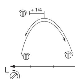
**REMARQUE!** Si l'équipement de coupe tourne au ralenti, tourner le pointeau de ralenti T dans le sens contraire des aiguilles jusqu'à l'arrêt de l'équipement de coupe.
