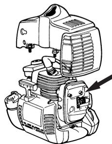
Certains silencieux sont munis d'une grille pare-étincelles. Cette grille doit être nettoyée une fois par semaine si la machine en est équipée. Utiliser de préférence une brosse en acier. Sur les silencieux sans pot catalytique, la grille doit être nettoyée et si nécessaire remplacée une fois par semaine. Sur les machines dont le silencieux est muni d'un pot
