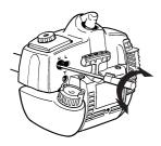
Donner les pleins gaz et tourner le pointeau haut-régime H très lentement dans le sens des aiguilles d'une montre jusqu'au ralentissement du moteur. Tourner ensuite le pointeau haut-régime H très lentement dans le sens inverse jusqu'à ce que le moteur tourne de manière irrégulière. Tourner ensuite légèrement le pointeau haut-régime H dans le sens des aiguilles d'une montre jusqu'à ce que le moteur tourne de manière régulière.
