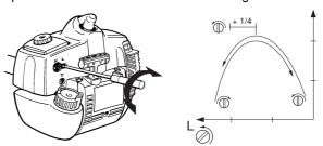
REMARQUE! Si l'équipement de coupe tourne au ralenti, tourner le pointeau de ralenti T dans le sens contraire des aiguilles jusqu'à l'arrêt de l'équipement de coupe.
