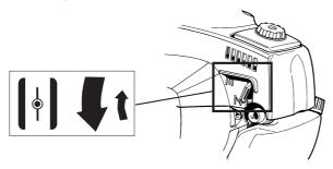
Pompe à carburant: Appuyer sur la poche en caoutchouc de la pompe à carburant plusieurs fois jusqu'à ce que le carburant commence à remplir la poche. Il n'est pas nécessaire de remplir la poche complètement.
