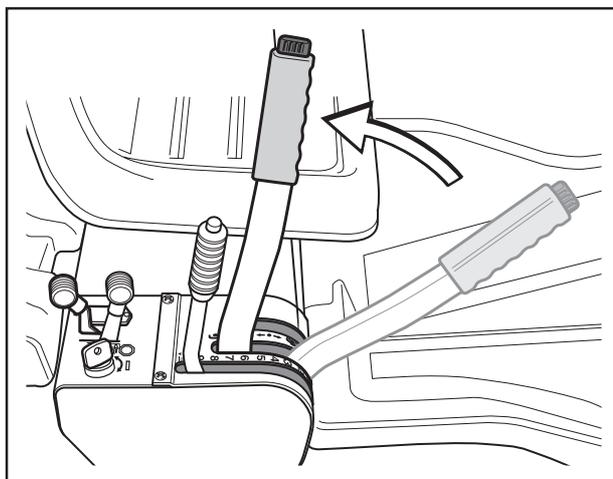
2. Amenez la commande des gaz en position "MIN". Tournez la clé de contact en position "STOP".
