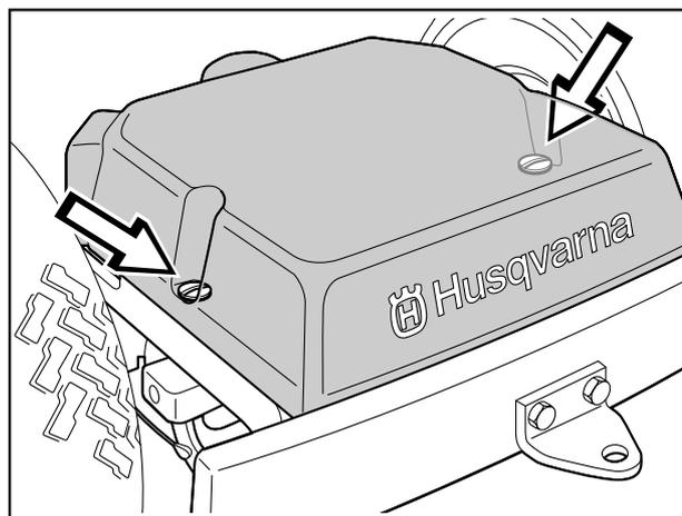
2. Contrôler que le réservoir d'huile de la transmission est bien rempli d'huile. Remplir, si nécessaire, avec de l'huile moteur SAE 10W/30 (classe SF-CC).
