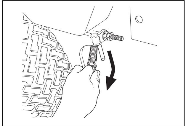
6. Placer un pied sur le bord avant de l'unité, près de la roue et lever le bord avant de l'unité pour décrocher plus facilement la barre de réglage de la hauteur.
