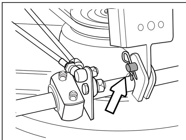
4. Pousser le cadre vers le bas et mettre en place la clavette. Placer la courroie d'entraînement autour de la roue d'entraînement de l'unité de coupe.
