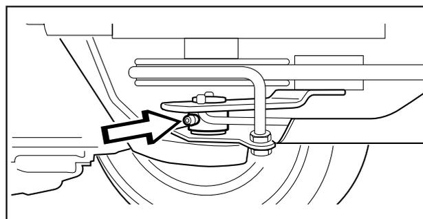
\* Les graisses de marques connues (station d'essence, etc.) sont généralement de bonne qualité. Le plus important est que la graisse offre une bonne protection contre la corrosion.
