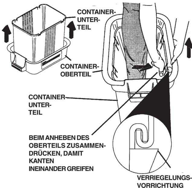
**DICHTHEITSPRÜFUNG:** Drücken Sie die Seiten des Containerunterteils leicht zusammen und vergewissern Sie sich, dass es keine Lücken zwischen unterer und oberer Hälfte gibt. Falls eine Lücke zu sehen ist, lösen Sie die Verriegelungsvorrichtungen, nehmen Sie die Containerhälften auseinander und wiederholen Sie den oben beschriebenen Vorgang.
