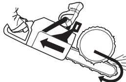
Wenn der Anwender die nach hinten schiebende Kraft der Motorsäge nicht durch seine Körperkraft ausgleicht, besteht die Gefahr, dass die Motorsäge sich so weit nach hinten schiebt, dass nur noch der Rückschlagbereich Kontakt mit dem Baumstamm hat und ein Rückschlag ausgelöst wird.
