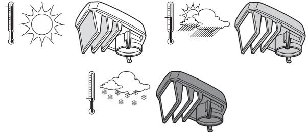
Ein Luftfilter, der längere Zeit verwendet wurde, wird nie vollkommen sauber. Der Luftfilter ist daher in regelmäßigen Abständen auszuwechseln. **Beschädigte Filter sind immer auszuwechseln.**
