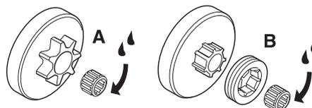
Beide Varianten haben ein eingebautes Nadellager an der Abtriebswelle, das regelmäßig geschmiert werden muss (einmal wöchentlich).
