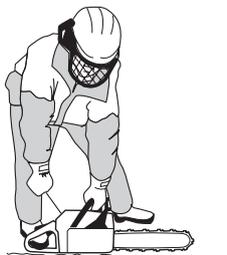
Halten Sie die Motorsäge mit festem Griff, in dem Sie die Handgriffe fest mit Daumen und Fingern umschließen.
