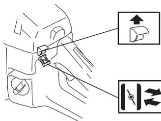
Startvorgang wie bei kaltem Motor, der Chokehebel wird jedoch nicht in Choke-Lage geführt. Mit dem Kombinationshebel Choke/Startgas erhält man Startgas, indem der Hebel in Choke-Lage geführt und gleich wieder eingeschoben wird.
