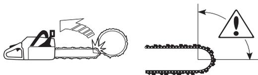
Ein Rückschlag ist immer in Richtung der Führungsschiene gerichtet. Am häufigsten erfolgt der Stoß von Motorsäge und Führungsschiene nach oben und nach hinten zum Anwender. Rückschläge erfolgen aber auch in andere Richtungen, je nachdem in welcher Stellung sich die Motorsäge in dem Augenblick befindet, in dem der Rückschlagbereich mit einem Gegenstand in Berührung kommt.
