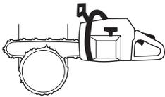
Es gibt Methoden zum Fällen von Bäumen, deren Stammdurchmesser größer ist als die Führungsschielenlänge. Bei solchen Methoden besteht große Gefahr, dass der Rückschlagbereich der Führungsschiene mit einem Gegenstand in Berührung kommt.
