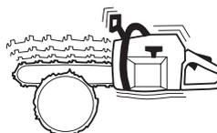
Das Sägen in einer harten Holzart (meist Laubbäume) verursacht mehr Vibrationen als das Sägen in weichem Holz (meist Nadelbäume). Durch das Sägen mit einer falschen, ungeschärften oder falsch geschärften Schneidausrüstung werden die Vibrationen erhöht. Siehe die Anweisungen unter der Überschrift Schneidausrüstung.
