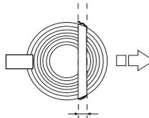
Das Brechmaß funktioniert wie ein Scharnier, das die Richtung des fallenden Baumstamms bestimmt.
