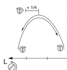
Durch langsames Hinein- oder Herausschrauben der Düse die höchste Leerlaufdrehzahl suchen. Wenn die höchste Drehzahl erreicht ist, die L-Düse 1/4 Umdrehung gegen den Uhrzeigersinn drehen.
