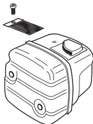
Bestimmte Schalldämpfer sind mit einem speziellen Funkenfangnetz ausgerüstet. Ist Ihr Gerät mit einem derartigen Schalldämpfer ausgestattet, so ist das Netz einmal wöchentlich zu säubern. Dies geschieht am besten mit einer Stahlbürste.
