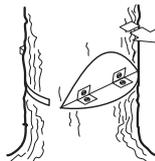
Man verliert völlig die Kontrolle über die Fallrichtung des Baumes, wenn das Brechmaß zu klein oder durchgesägt ist oder wenn Kerb- und Fällschnitt an falscher Stelle ausgeführt wurden.
