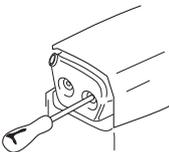
Ist der Schalldämpfer Ihres Gerätes mit einem Funkenfangnetz versehen, muss dieses regelmäßig gereinigt werden. Ein verstopftes Netz verursacht ein Heißlaufen des Motors mit schweren Motorschäden als Folge.
