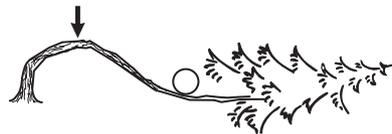
Überlegen Sie, wie die Spannung am sichersten beseitigt werden kann, und ob Sie dies schaffen. Ist die Situation zu kompliziert, gibt es nur eine sichere Methode nämlich anstelle der Motorsäge eine Winde zu benutzen.
