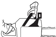
Geben Sie Vollgas und betätigen Sie die Kettenbremse, indem Sie das linke Handgelenk gegen den Handschutz drehen. Lassen Sie den vorderen Handgriff nicht los. **Die Kette soll sofort stoppen.**
