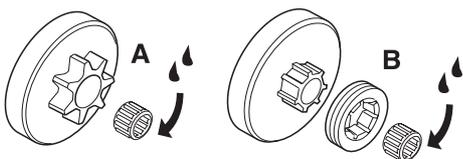
Beide Varianten haben ein eingebautes Nadellager an der Abtriebswelle, das regelmäßig geschmiert werden muss (einmal wöchentlich). ACHTUNG! Immer hochqualitatives Lagerfett oder Motoröl verwenden.
