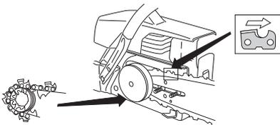
Darauf achten, dass die Schneiden der Sägezähne auf der Schienenoberseite nach vorn gerichtet sind.
