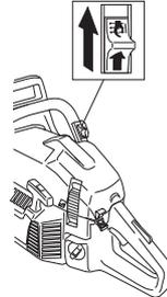
Wird der Schalter nach oben geschoben, schaltet sich die Heizung ein. Wird der Schalter nach unten geschoben, geht die Heizung aus.
