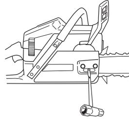
Die Kette ist richtig gespannt, wenn sie an der Schienenunterseite nicht durchhängt und noch leicht von Hand durchgezogen werden kann. Die Schienenspitze anheben und dabei gleichzeitig die Schienenmuttern mit dem Kombischlüssel festschrauben.
