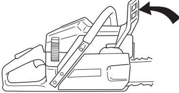
Die Schienenmuttern lösen und den Kupplungsdeckel (Kettenbremse) abnehmen. Den Transportschutz (A) entfernen.
