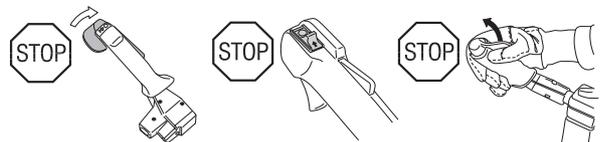
Den Motor starten und kontrollieren, ob der Motor stoppt, wenn der Stoppschalter in Stopstellung geführt wird.
