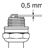
**ACHTUNG!** Stets den vom Hersteller empfohlenen Zündkerzentyp verwenden! Eine ungeeignete Zündkerze kann Kolben und Zylinder zerstören. Dafür sorgen, dass die Zündkerze eine sog. Funkenstörung hat.
