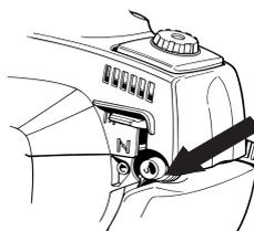
**Choke:** Den Chokehebel in Choke-Lage führen.
