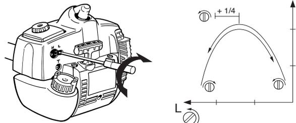
**ACHTUNG!** Wenn die Schneidausrüstung sich im Leerlauf dreht, ist die T-Schraube gegen den Uhrzeigersinn zu drehen, bis die Schneidausrüstung stehenbleibt.
