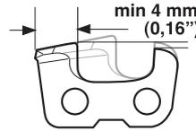
Wenn die Schneidezähne nur noch eine Länge von 4 mm haben, ist die Sägekette verschlissen und muss weggeworfen werden.
