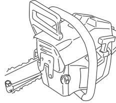
Die Kette ist richtig gespannt, wenn sie an der Schienenunterseite nicht durchhängt und noch leicht von Hand durchgezogen werden kann. Die Schienenmuttern mit dem Kombischlüssel festschrauben.
