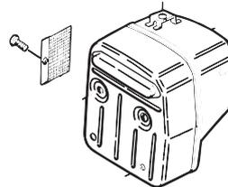
Bestimmte Schalldämpfer sind mit einem speziellen Funkenfangnetz ausgerüstet. Ist Ihr Gerät mit einem derartigen Schalldämpfer ausgestattet, so ist das Netz einmal wöchentlich zu säubern. Dies geschieht am besten mit einer Stahlbürste.
