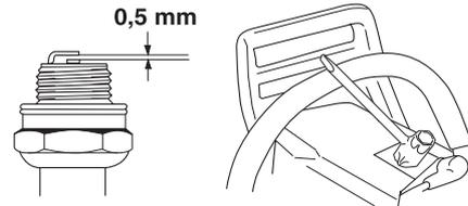
**ACHTUNG!** Stets den vom Hersteller empfohlenen Zündkerzentyp verwenden! Eine ungeeignete Zündkerze kann Kolben und Zylinder zerstören.
