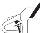
Die Gashebelsperre eindrücken und kontrollieren, ob sie in die Ausgangsstellung zurückkehrt, wenn sie losgelassen wird.
