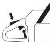
Die Motorsäge starten und Vollgas geben. Gashebel loslassen und kontrollieren, ob die Kette stoppt und still stehenbleibt. Dreht sich die Kette, wenn der Gashebel in Leerlaufstellung steht, muss die Leerlaufeinstellung des Vergasers kontrolliert werden.
