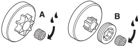
Beide Varianten haben ein eingebautes Nadellager an der Abtriebswelle, das regelmäßig geschmiert werden muss (einmal wöchentlich).
