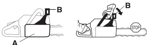
Diese Bewegung betätigt einen federgespannten Mechanismus, der das Bremsband (C) um das Kettenantriebssystem (D) des Motors spannt (Kupplungstrommel).
