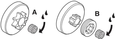
Beide Varianten haben ein eingebautes Nadellager an der Abtriebswelle, das regelmäßig geschmiert werden muss (einmal wöchentlich). ACHTUNG! Immer hochqualitatives Lagerfett oder Motoröl verwenden.
