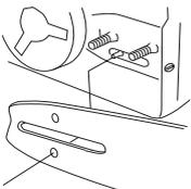
Die Kette durch Drehen der Kettenspannschraube im Uhrzeigersinn (einen Kombischlüssel verwenden) spannen. Die Kette soll gespannt werden, bis sie auf der Schienenunterseite nicht mehr durchhängt.
