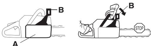
Ce mouvement actionne un mécanisme à ressort qui tend le ruban du frein (C) autour du système d'entraînement de la chaîne (D) (le tambour d'embrayage).
