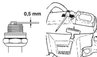
**REMARQUE!** Toujours utiliser le type de bougie recommandé! Une bougie incorrecte peut endommager le piston/le cylindre.
