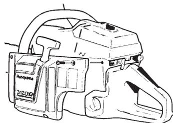
Nettoyer le système de refroidissement avec une brosse une fois par semaine, voire plus souvent dans des conditions difficiles. Un système de refroidissement sale ou colmaté provoque la surchauffe de la machine, endommageant le cylindre et le piston.
