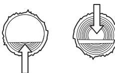
**Les deux extrémités du tronc reposent sur des supports.** Risque important de coincage de la chaîne.
