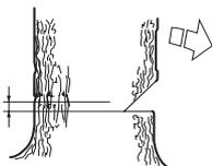
Placer le patin d'ébranchage (s'il y en a un de monté) derrière la charnière. Scier à plein régime et enfoncer graduellement le guide-chaîne dans le tronc. Attention si l'arbre se déplace dans le sens opposé au sens de chute choisi. Introduire un coin ou un bras de levier dans le trait de chute dès que la profondeur de coupe le permet.
