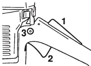
Si la machine est équipée d'un décompresseur (A): enfoncer celui-ci pour réduire la pression dans le cylindre et faciliter le démarrage de la machine. Toujours utiliser le décompresseur au démarrage. Une fois le moteur lancé, le décompresseur se remet automatiquement en position initiale.
