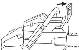
**Démarrage:** Le frein de chaîne doit être activé quand la tronçonneuse est démarrée. Activer le frein en poussant la protection anti-rebond vers l'avant.
