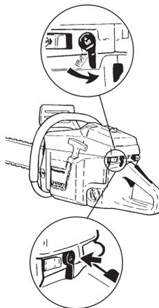
Remarque: Il n'est pas nécessaire de pomper sans arrêt. Lorsque le flux supplémentaire d'huile est activé, la consommation d'huile augmente de 40-80%, en fonction du réglage de base de la pompe à huile.
