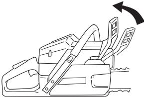
Déposer les écrous du guide-chaîne et le carter d'embrayage (frein de chaîne). Déposer la protection de transport (A).
