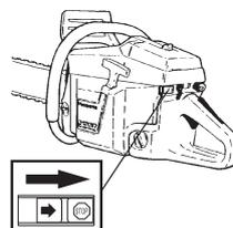
Pour arrêter le moteur, couper l'allumage. (Mettre le contacteur en position d'arrêt.)
