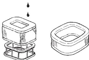
Un filtre ayant servi longtemps ne peut plus être complètement nettoyé. Le filtre à air doit donc être remplacé à intervalles réguliers. **Tout filtre endommagé doit être remplacé immédiatement.**
