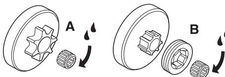
Ces deux types de pignon comportent au niveau de l'arbre de sortie un roulement à aiguilles qui doit être graissé régulièrement (1 fois par semaine). REMARQUE! Utiliser de la graisse pour paliers de bonne qualité ou de l'huile moteur.
