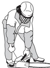
Saisir la poignée avant avec la main gauche. Placer le pied droit sur la partie inférieure de la poignée arrière et appuyer la tronçonneuse sur le sol. Prendre la poignée du lanceur, tirer lentement avec la main droite jusqu'à sentir une résistance (les cliquets se mettent en prise) et tirer plusieurs fois rapidement et avec force jusqu'au démarrage du moteur.
