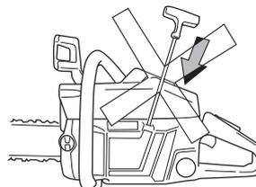
Enfoncer la commande du starter dès que le moteur s'allume et répéter les lancements jusqu'au démarrage. Quand le moteur démarre, accélérer rapidement à fond, ce qui en même temps supprime le ralenti accéléré.
