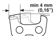
Si la hauteur de dent est inférieure à 4 mm, la chaîne est usée et doit être remplacée.
