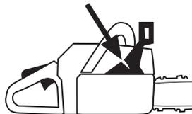
Actionner l'arceau d'avant en arrière pour s'assurer qu'il se meut librement et qu'il est solidement fixé à son articulation dans le carter d'embrayage.
