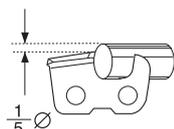
Affûter une chaîne sans outils spéciaux est très difficile. Il est donc recommandé d'utiliser notre gabarit. Il assure un affûtage de coupe maximal et une réduction optimale du risque de rebond.
