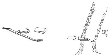
Nous recommandons une longueur de guide-chaîne supérieure au diamètre du tronc, ce qui simplifie que le trait de chute et l'encoche s'effectuent avec un simple trait de scie. Voir aux Caractéristiques techniques les longueurs de guide-chaîne recommandées pour chaque modèle de tronçonneuse.
