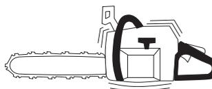
Les vibrations se produisant lors de toute utilisation sont dues à un contact irrégulier entre la chaîne et la pièce à scier durant le sciage.
