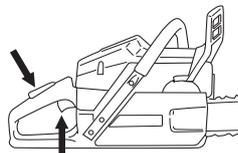
Le frein de chaîne étant encore activé, le régime du moteur doit être mis sur le ralenti le plus vite possible en déconnectant rapidement la gâchette d'accélération. De cette manière, toute usure inutile de l'embrayage, du tambour d'embrayage et de la bande de frein peut être évitée.
