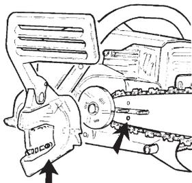
Tendre la chaîne en tournant la vis du tendeur de chaîne vers la droite à l'aide de la clé universelle. Tendre la chaîne jusqu'à ce qu'elle ne pende plus sous le guide.
