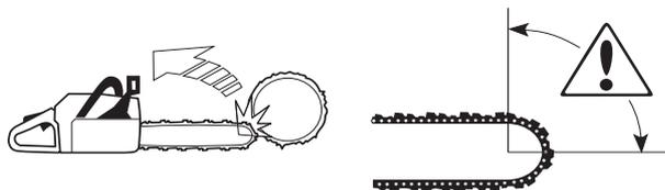
Le tronçonnage avec la partie inférieure de la chaîne, c'est à dire par dessus (de haut en bas), s'appelle méthode "tirée". La tronçonneuse est attirée vers l'arbre et le bord avant de la tronçonneuse devient un appui naturel contre l'arbre. Dans ce cas, l'utilisateur contrôle mieux à la fois sa tronçonneuse et la zone de rebond du nez.
