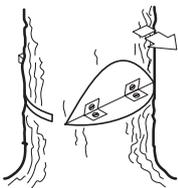
Le contrôle de la direction de chute de l'arbre fonctionne mal si la charnière est trop petite ou coupée trop profondément ou si les deux entailles ne coïncident pas.
