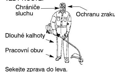
**⚠️ VÝSTRAHA:** Vždy nosete osobní prostředky na ochranu očí a obličeje. Nikdy se nenakláňejte nad strunovou hlavu. Odléhající nečistoty a kamínky by mohly způsobit oslepnutí nebo jiné vážné poranění obličeje. Nenechávejte motor běžet na vyšší otáčky než je zapotřebí. Vyžinací struna bude vyžívat efektivně, i když motor nepoběží na plný plyn. Při nižších otáčkách motoru je nižší hladina hluku motoru i vibrací. Vyžinací struna vydří dle.
