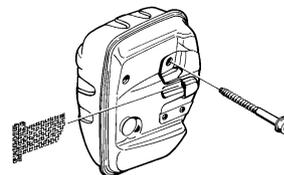
Sur les silencieux sans pot catalytique, la grille doit être nettoyée et si nécessaire remplacée une fois par semaine. Sur les machines dont le silencieux est muni d'un pot catalytique, la grille devra être inspectée et si nécessaire nettoyée une fois par mois. **Si la grille est abîmée, elle devra être remplacée.**
