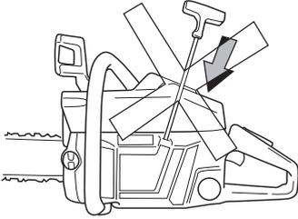
Tirer l'arceau protecteur vers la poignée avant. Le frein de chaîne est alors libéré. La tronçonneuse est maintenant prête à être utilisée.
