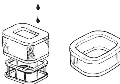
Un filtre ayant servi longtemps ne peut plus être complètement nettoyé. Le filtre à air doit donc être remplacé à intervalles réguliers. **Tout filtre endommagé doit être remplacé immédiatement.**
