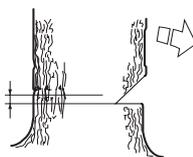
Scier à plein régime et enfoncez graduellement le guide-chaîne dans le tronc. Attention si l'arbre se déplace dans le sens opposé au sens de chute choisi. Introduire un coin ou un bras de levier dans le trait de chute dès que la profondeur de coupe le permet.
