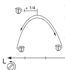
Visser le pointeau L dans le sens des aiguilles d'une montre jusqu'à l'arrêt. Si le moteur a une mauvaise accélération ou un ralenti irrégulier, visser le pointeau L dans le sens inverse des aiguilles d'une montre jusqu'à obtention d'une bonne accélération et d'un ralenti régulier.
