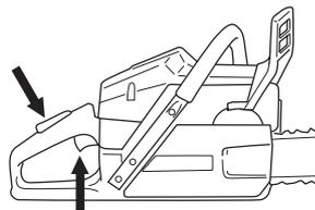
Enfoncer la commande de starter dès que le moteur s'emballe et répéter les lancements jusqu'au démarrage. Dès que le moteur démarre, appuyer et relâcher immédiatement la commande d'accélération. Ceci libère la gâchette d'accélération.
