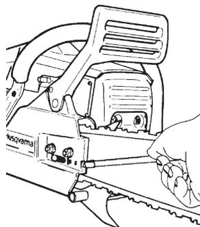
La chaîne est tendue correctement quand elle ne pend plus sous le guide et peut être avancée à la main sans difficulté. Serrer les écrous du guide à l'aide de la clé universelle tout en maintenant levé le pignon du guide.
