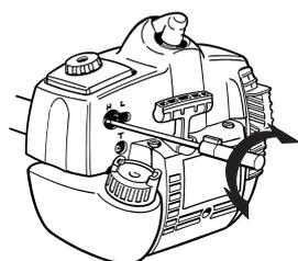
Donner les pleins gaz et tourner le pointeau haut-régime H très lentement dans le sens des aiguilles d'une montre jusqu'au ralentissement du moteur. Tourner ensuite le pointeau haut-régime H très lentement dans le sens inverse jusqu'à ce que le moteur tourne de manière irrégulière.
