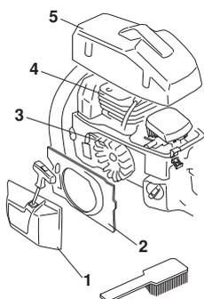
Nettoyer le système de refroidissement avec une brosse une fois par semaine, voire plus souvent dans des conditions difficiles. Un système de refroidissement sale ou colmaté provoque la surchauffe de la machine, endommageant le cylindre et le piston.
