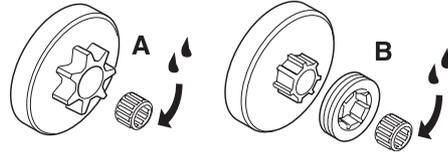
Ces deux types de pignon comportent au niveau de l'arbre de sortie un roulement à aiguilles qui doit être graissé régulièrement (1 fois par semaine).
