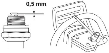
REMARQUE! Toujours utiliser le type de bougie recommandé! Une bougie incorrecte peut endommager le piston/le cylindre.
