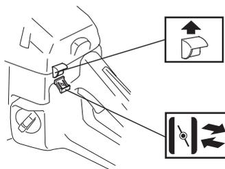
Procéder comme pour le démarrage du moteur froid, mais sans starter. Le ralenti accéléré est sélectionné en tirant puis en repoussant la commande de starter.
