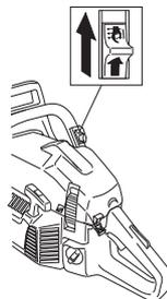
Pour mettre le chauffage, pousser le contact vers le haut. Pour couper le chauffage, pousser le contact vers le bas.
