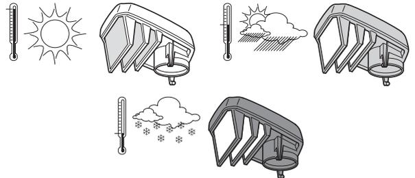
Un filtre ayant servi longtemps ne peut plus être complètement nettoyé. Le filtre à air doit donc être remplacé à intervalles réguliers. **Tout filtre endommagé doit être remplacé immédiatement.**
