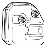
Le risque d'incendie est important dans les pays au climat chaud et sec. C'est pourquoi nous avons équipé certains silencieux de grilles antinflamme. Vérifier si le silencieux de la machine est muni d'un tel dispositif.
