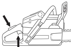
Dans la mesure où le frein de chaîne est encore activé, le moteur doit repasser le plus tôt possible au ralenti en libérant la gâchette d'accélération afin d'éviter toute usure inutile de l'embrayage.
