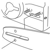
Tendre la chaîne en tournant la vis du tendeur de chaîne vers la droite à l'aide de la clé universelle. Tendre la chaîne jusqu'à ce qu'elle ne pende plus sous le guide.
