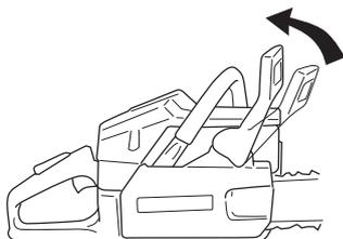
Déposer les écrous du guide-chaîne et le carter d'embrayage (frein de chaîne). Déposer la protection de transport (A).
