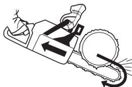
Il importe de résister à la poussée en arrière du guide-chaîne. En effet, si le guide-chaîne est repoussé suffisamment en arrière pour que la zone de rebond du nez se trouve en contact avec l'arbre, un rebond peut se produire.
