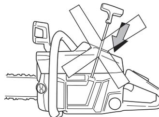
Enfoncer la commande de starter dès que le moteur s'emballe et répéter les lancements jusqu'au démarrage. Dès que le moteur démarre, appuyer et relâcher immédiatement la commande d'accélération. Ceci libère la gâchette d'accélération.
