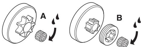
Ces deux types de pignon comportent au niveau de l'arbre de sortie un roulement à aiguilles qui doit être graissé régulièrement (1 fois par semaine). REMARQUE! Utiliser de la graisse pour paliers de bonne qualité ou de l'huile moteur.
