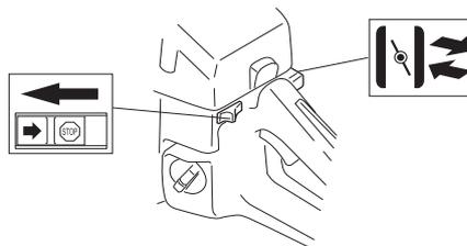
Procéder comme pour le démarrage du moteur froid, mais sans starter. Le ralenti accéléré est sélectionné en tirant puis en repoussant la commande de starter.
