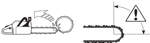
Le tronçonnage avec la partie inférieure de la chaîne, c'est à dire par dessus (de haut en bas), s'appelle méthode "poussée". La tronçonneuse est attirée vers l'arbre et le bord avant de la tronçonneuse devient un
