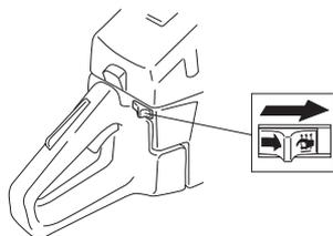
Pour mettre le chauffage, pousser le contact à droite. Pour couper le chauffage, pousser le contact à gauche.
