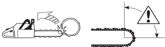
Le rebond se produit toujours dans le plan du guide-chaîne. En général, tronçonneuse et guide-chaîne sont relevés simultanément en direction de l'utilisateur. Néanmoins, la
