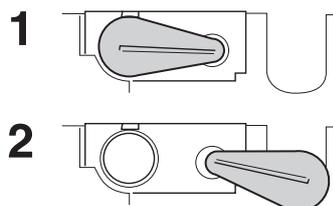
**REMARQUE!** Quand le bouchon est posé dans la buse d'air "Air injection", le filtre à air doit être nettoyé au moins une fois par jour.
