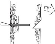
Le trait de chute doit s'achever parallèlement à l'encoche, l'espace entre les deux étant 1/10 du diamètre du tronc. La partie non coupée du tronc s'appelle la charnière.
