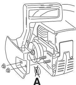
Positionner le guide-chaîne sur les écrous et l'amener à sa position la plus reculée. Placer la chaîne sur le pignon d'entraînement et dans la gorge du guide-chaîne. Commencer par le dessus du guide.
