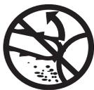
Un contact de la pointe peut provoquer un mouvement soudain du guide-chaîne vers le haut et l'arrière et ainsi causer des blessures graves. Prière de vous reporter aux pages 12 à 21 de votre Manuel de sécurité de l'utilisateur d'une tronçonneuse.
