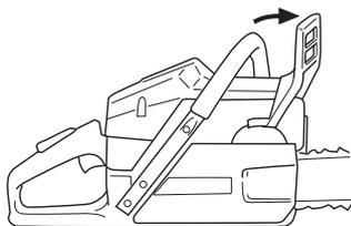
**Démarrage:** Le frein de chaîne doit être activé lors du démarrage de la tronçonneuse. Activer le frein de chaîne en poussant l'arceau protecteur vers l'avant.
