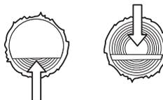
**Les deux extrémités du tronc reposent sur des supports.** Risque important de coincage de la chaîne.
