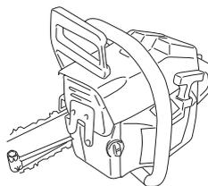
La chaîne est tendue correctement quand elle ne pend plus sous le guide et peut être avancée à la main sans difficulté. Serrer les écrous du guide à l'aide de la clé universelle tout en maintenant levé le pignon du guide.
