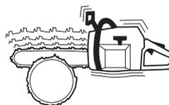
Le sciage de bois durs (la plupart des feuillus) produit davantage de vibrations que celui des bois tendres (la plupart des conifères). Si la chaîne est mal affûtée ou défectueuse (type inadéquat ou affûtage défectueux), le taux de vibrations augmente. Voir les instructions au chapitre Équipement de coupe.
