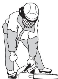
Saisir la poignée avant avec la main gauche. Placer le pied droit sur la partie inférieure de la poignée arrière et appuyer la tronçonneuse sur le sol. Prendre la poignée du lanceur, tirer lentement avec la main droite jusqu'à sentir une résistance (les cliquets se mettent en prise) et tirer plusieurs fois rapidement et avec force jusqu'au démarrage du moteur. **Ne jamais enrouler la corde du lanceur autour de la main.**
