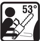
Taux de rebond maximum mesuré sans activer le frein de chaîne, pour la combinaison de guide-chaîne et chaîne indiquée sur l'étiquette.
