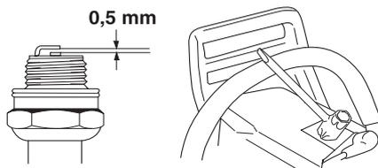
**REMARQUE!** Toujours utiliser le type de bougie recommandé! Une bougie incorrecte peut endommager le piston/le cylindre.
