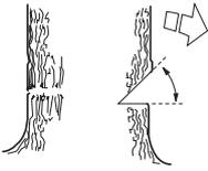
La ligne de jointure entre les deux entailles s'appelle le trait de chute. Le trait de chute doit être horizontal et former un angle de 90° avec le sens de chute prévu.
