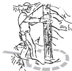
Dégager les taillis autour du tronc et éviter les obstacles tels que pierres, branches cassées, fondrières, etc. pour s'assurer d'une voie de retraite facile au moment de la chute. La voie de retraite doit être à 135° derrière le sens de chute prévu de l'arbre.
