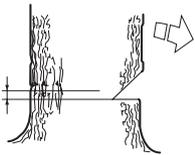
Scier à plein régime et enfoncer graduellement le guide-chaîne dans le tronc. Attention si l'arbre se déplace dans le sens opposé au sens de chute choisi. Introduire un coin ou un bras de levier dans le trait de chute dès que la profondeur de coupe le permet.
