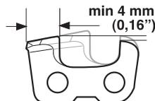
Si la hauteur de dent est inférieure à 4 mm, la chaîne est usée et doit être remplacée.
