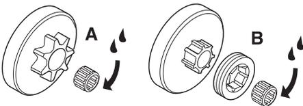
Ces deux types de pignon comportent au niveau de l'arbre de sortie un roulement à aiguilles qui doit être graissé régulièrement (1 fois par semaine).
