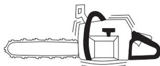
Les vibrations se produisant lors de toute utilisation sont dues à un contact irrégulier entre la chaîne et la pièce à scier durant le sciage.
