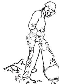
Ne se déplacer qu'avec le tronc entre soi et la tronçonneuse.
