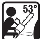
Taux de rebond maximum mesuré sans activer le frein de chaîne, pour la combinaison de guide-chaîne et chaîne indiquée sur l'étiquette.
