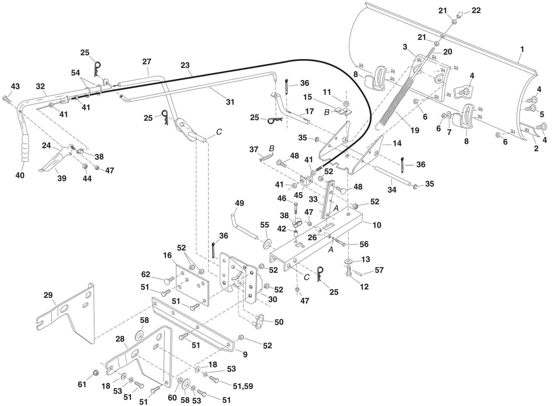
**REPAIR PARTS FOR MODEL 490-900-0030 - 48" SNOW BLADE**
