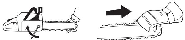
Die Spanschraube der Sägekette befindet sich bei unseren Motorsägenmodellen an unterschiedlichen Positionen. Siehe die Anweisungen unter der Überschrift Was ist was? bezüglich der Position der Spanschraube an Ihrem Modell.
