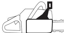
Vorsichtig arbeiten und dafür sorgen, dass der Rückschlagbereich der Führungsschiene nicht mit einem Gegenstand in Berührung kommt.
