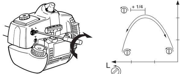
**REMARQUE!** Si l'équipement de coupe tourne au ralenti, tourner le pointeau de ralenti T dans le sens contraire des aiguilles jusqu'à l'arrêt de l'équipement de coupe.
