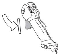
Appuyer sur le blocage de l'accélération et vérifier qu'il revient de lui-même en position initiale quand il est relâché.
