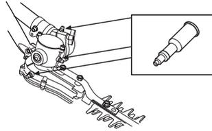
**ACHTUNG!** Das Getriebe darf nicht ganz mit Fett gefüllt werden. Das Fett dehnt sich durch die beim Betrieb des Gerätes entstehende Wärme aus. Ist das Getriebe ganz voll Fett, besteht die Gefahr, dass Dichtungen zerstört werden und Fett austritt.
