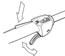
Siehe die Anweisungen unter der Überschrift Start. Die Heckenschere starten und Vollgas geben. Den Gashebel loslassen und kontrollieren, ob die Messer völlig zum Stillstand kommen. Wenn die Messer sich bewegen, während sich der Gashebel in Leerlaufstellung befindet, ist der Leerlauf des Vergasers einzustellen. Siehe die Anweisungen unter der Überschrift Wartung.
