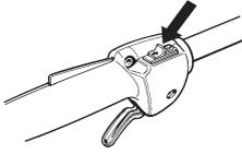
Den Motor starten und kontrollieren, ob der Motor stoppt, wenn der Stopschalter in Stopstellung geführt wird.
