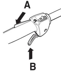
Kontrollieren, ob der Gashebel in Leerlaufstellung gesichert ist, wenn sich die Gashebelsperre in Ausgangsstellung befindet.
