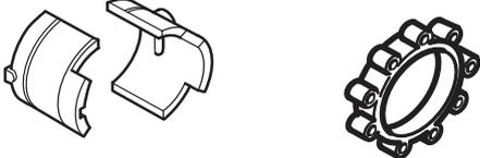
Die Antivibrationselemente regelmäßig auf Risse und Verformungen überprüfen. Kontrollieren, ob die Vibrationsdämpfer unbeschädigt und fest verankert sind.
