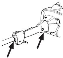
Das Antivibrationssystem reduziert die Übertragung von Vibrationen zwischen Motoreinheit/Schneidausrüstung und dem Handgriffssystem des Gerätes.
