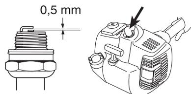
**ACHTUNG!** Stets den vom Hersteller empfohlenen Zündkerzentyp verwenden! Eine ungeeignete Zündkerze kann Kolben und Zylinder zerstören. Dafür sorgen, dass die Zündkerze eine sog. Funkentstörung hat.
