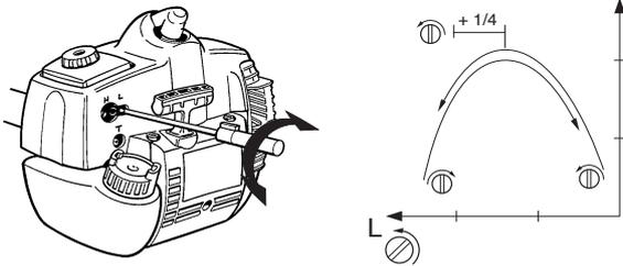
**ACHTUNG!** Wenn die Schneidausrüstung sich im Leerlauf dreht, ist die T-Schraube gegen den Uhrzeigersinn zu drehen, bis die Schneidausrüstung stehenbleibt.
