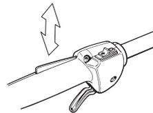
Kontrollieren, ob Gashebel und Gashebelsperre mit dem dazugehörigen Rückzugfedersystem leicht funktionieren.
