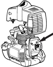
Bestimmte Schalldämpfer sind mit einem speziellen Funkenfangnetz ausgerüstet. Ist Ihr Gerät mit einem derartigen Schalldämpfer ausgestattet, so ist das Netz einmal wöchentlich zu säubern. Dies geschieht am besten mit einer Stahlbürste.
