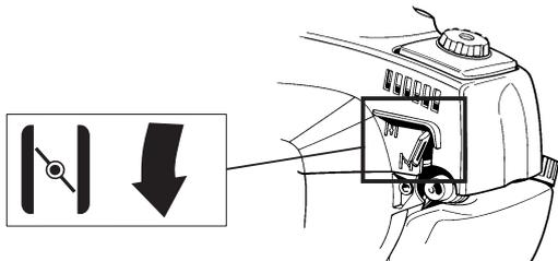
Den Gerätekörper mit der linken Hand gegen den Boden drücken (**ACHTUNG!** Nicht mit dem Fuß!). Mit der rechten Hand den Starthandgriff fassen und das Startseil langsam herausziehen, bis ein Widerstand spürbar wird (die Starthaken greifen), und dann schnell und kräftig ziehen. **Das Startseil niemals um die Hand wickeln.**
