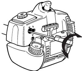
Vollgas geben und die Hochdrehzahldüse H sehr langsam im Uhrzeigersinn drehen, bis die Motorgeschwindigkeit abnimmt. Anschließend die Hochdrehzahldüse H sehr langsam gegen den Uhrzeigersinn drehen, bis der Motor ungleichmäßig läuft. Danach die Hochdrehzahldüse H langsam geringfügig im Uhrzeigersinn drehen, bis der Motor gleichmäßig läuft.
