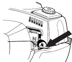
**Choke:** Den Chokehebel in Choke-Lage führen.
