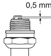
**ACHTUNG!** Stets den vom Hersteller empfohlenen Zündkerzentyp verwenden! Eine ungeeignete Zündkerze kann Kolben und Zylinder zerstören. Dafür sorgen, dass die Zündkerze eine sog. Funkentstörung hat.
