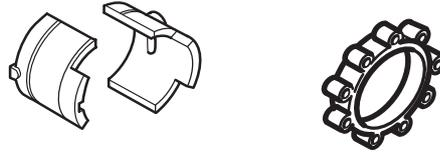
Die Antivibrationselemente regelmäßig auf Risse und Verformungen überprüfen. Kontrollieren, ob die Vibrationsdämpfer unbeschädigt und fest verankert sind.
