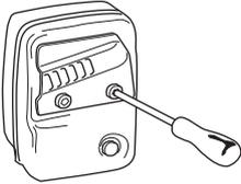
Ist der Schalldämpfer Ihres Gerätes mit einem Funkenfangnetz versehen, muss dieses regelmäßig gereinigt werden. Ein verstopftes Netz verursacht ein Heißlaufen des Motors mit schweren Motorschäden als Folge.
