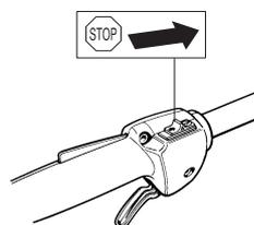
**ACHTUNG!** Der Stoppschalter geht automatisch in die Startstellung zurück. Um ein ungewolltes Starten zu vermeiden, muss bei Montage, Kontrolle und/oder Wartung daher stets die Zündkappe von der Zündkerze entfernt werden.
