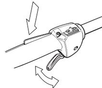
Siehe die Anweisungen unter der Überschrift Start. Gerät starten und Vollgas geben. Den Gashebel loslassen und kontrollieren, ob die Schneidausrüstung völlig zum Stillstand kommt. Wenn die Schneidausrüstung rotiert, während sich der Gashebel in Leerlaufstellung befindet, ist die Leerlaufeinstellung des Vergasers zu kontrollieren. Siehe die Anweisungen unter der Überschrift Wartung.
