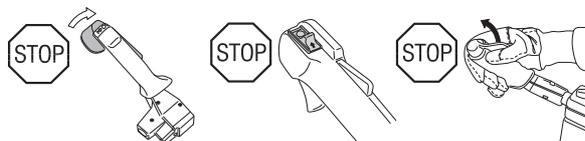
Mettre le moteur en marche et s'assurer qu'il s'arrête lorsque le bouton d'arrêt est amené en position d'arrêt.
