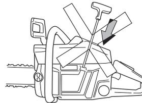
Die Kettenbremse rückstellen, indem der Handschutz zum Handgriffbügel geführt wird. Damit ist die Motorsäge bereit zur Anwendung.
