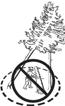
Am sichersten ist die Benutzung einer Winde.
