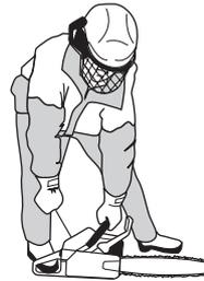
Da die Kettenbremse immer noch eingeschaltet ist, muss die Motordrehzahl so schnell wie möglich auf Leerlauf herunter, was durch ein schnelles Ausschalten der Gassperre erreicht wird. Dadurch vermeiden Sie unnötigen Verschleiß an Kupplung, Kupplungstrommel und Bremsband.
