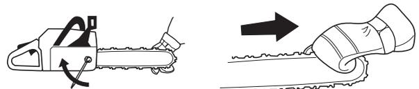
Die Spannschraube der Sägekette befindet sich bei unseren Motorsägenmodellen an unterschiedlichen Positionen. Siehe die Anweisungen unter der Überschrift Was ist was? bezüglich der Position der Spannschraube an Ihrem Modell.
