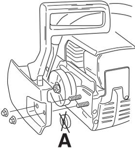
Die Schiene über die Schienenbolzen montieren. Die Schiene in der hintersten Position aufsetzen. Die Kette um das Kettenantriebsrad und in die Schienennut legen. Auf der Oberseite der Schiene beginnen. Darauf achten, dass die Schneiden der Sägezähne auf der Schienenoberseite nach vorn gerichtet sind.
