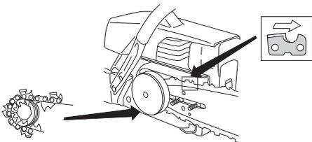
Kupplungsdeckel montieren und den Kettenspannzapfen in das Loch in der Schiene einpassen. Kontrollieren, ob die Treibglieder der Kette auf das Kettenantriebsrad passen und die Kette richtig in der Schienennut liegt. Die Schienenmuttern von Hand festschrauben.
