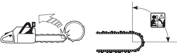
Ein Rückschlag ist immer in Richtung der Führungsschiene gerichtet. Am häufigsten erfolgt der Stoß von Motorsäge und Führungsschiene nach oben und nach hinten zum Anwender. Rückschläge erfolgen aber auch in andere Richtungen, je nachdem in welcher Stellung sich die Motorsäge in dem Augenblick befindet, in dem der Rückschlagbereich mit einem Gegenstand in Berührung kommt.
