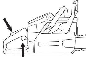
Sobald der Motor zündet, den Chokehebel einschieben und neue Startversuche machen, bis der Motor anspringt. Wenn der Motor anspringt, schnell Vollgas geben, und das Startgas schaltet sich automatisch aus.
