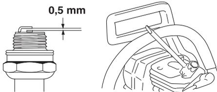
Hinweis! Stets den vom Hersteller empfohlenen Zündkerzentyp verwenden! Eine ungeeignete Zündkerze kann Kolben und Zylinder zerstören. Dafür sorgen, dass die Zündkerze eine sog. Funkenstörung hat.
