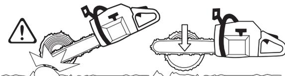
Wenn die Möglichkeit vorhanden ist (= kann der Stamm gedreht werden?), sollte der Stamm zu 2/3 durchgesägt werden.
