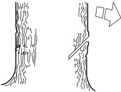
Dann einen Sägeschnitt von unten machen, der genau auf den Sägeschnitt von oben trifft.
