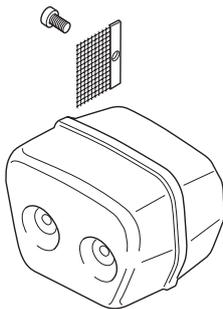
Der Schalldämpfer hat die Aufgabe, den Schallpegel zu dämpfen und die Abgase vom Anwender wegzuleiten. Die Abgase sind heiß und können Funken enthalten, die einen Brand verursachen können, wenn die Abgase auf trockenes und brennbares Material gerichtet werden.
