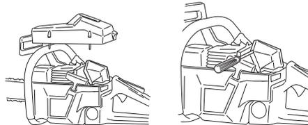
Eine gründlichere Reinigung erfolgt durch Auswaschen des Filters in Seifenwasser.
