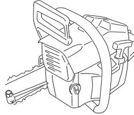
Die Kette ist richtig gespannt, wenn sie an der Schienenunterseite nicht durchhängt und noch leicht von Hand durchgezogen werden kann. Die Schienenspitze anheben und dabei gleichzeitig die Schienenmuttern mit dem Kombischlüssel festschrauben.
