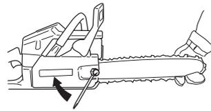
An einer neuen Kette muss die Kettenspannung oft kontrolliert werden, bis die Kette eingefahren ist. Die Kettenspannung regelmäßig prüfen. Mit einer richtig gespannten Kette wird eine gute Schnittleistung und eine lange Lebensdauer erzielt.
