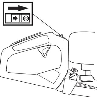
Den Motor starten und kontrollieren, ob der Motor stoppt, wenn der Stopschalter in Stopstellung geführt wird.
