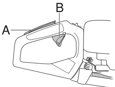
Kontrollieren, ob der Gashebel in Leerlaufstellung gesichert ist, wenn sich die Gashebelsperre in Ausgangsstellung befindet.
