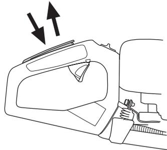
Kontrollieren, ob Gashebel und Gashebelsperre mit dem dazugehörigen Rückzugfedersystem leicht funktionieren.
