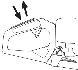
Vérifier que le blocage de l'accélération, la commande d'accélération et leurs ressorts de rappel fonctionnent correctement.
