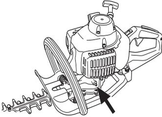
**REMARQUE!** L'engrenage ne doit pas être entièrement rempli de lubrifiant. Le lubrifiant se dilate sous l'effet de la chaleur qui se dégage lors du fonctionnement de la machine. Si l'engrenage est entièrement rempli de lubrifiant, les joints d'étanchéité risquent d'être endommagés, entraînant des fuites de lubrifiant.
