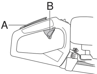
Vérifier d'abord que la commande de l'accélération est bloquée en position de ralenti quand le blocage de l'accélération est en position initiale.
