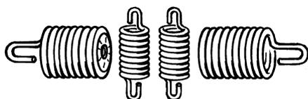
Vérifier régulièrement l'état des éléments afin de détecter fissures et déformations. Vérifier que les éléments anti-vibrations sont entiers et solidement fixés.
