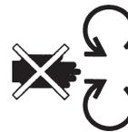
Es ist verboten, bei laufendem Motor die Hand oder den Fuß unter die Haube zu halten.
