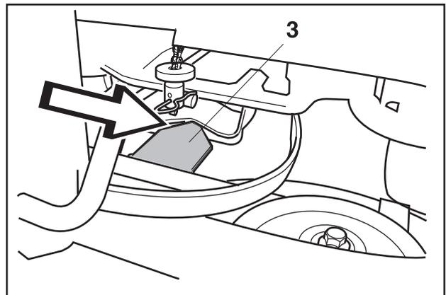
3. Den Bolzen einsetzen und mit einem Sicherungssplint sichern.
