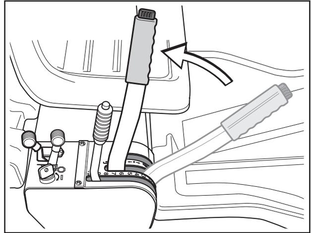
2. Den Gashebel in die Mittelstellung führen.
