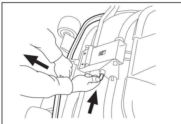
10. Schneidwerk an der Vorderkante herausziehen und in die Servicestellung aufstellen.
