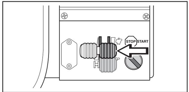
3. Wenn der Motor kalt ist, ist der Chokehebel bis zum Anschlag zurückzuziehen.
