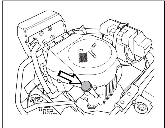
Der Ölstand muss zwischen den Markierungen auf dem Messstab liegen. Nähert sich der Ölstand der Marke "ADD", ist Öl bis zur Marke "FULL" auf dem Messstab nachzufüllen.
