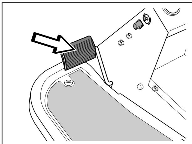
2. Appuyer doucement sur une des pédales jusqu'à l'obtention de la vitesse souhaitée.
