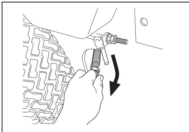
6. Placer un pied sur le bord avant de l'unité, près de la roue et lever le bord avant de l'unité pour décrocher plus facilement la barre de réglage de la hauteur.
