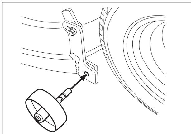
5. Retirer le ressort du galet tendeur de la courroie d'entraînement.
