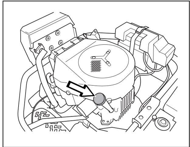
Le niveau d'huile doit se trouver entre les repères de la jauge. Si le niveau se rapproche du repère ADD, remplir d'huile jusqu'au repère FULL de la jauge.
