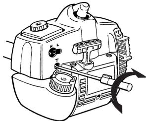
**IMPORTANT!** S'il est impossible de régler le régime de ralenti de manière à immobiliser l'équipement de coupe, contacter le revendeur ou l'atelier de réparation. Ne pas utiliser la machine tant qu'elle n'est pas correctement réglée ou réparée.
