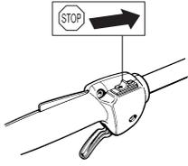
**REMARQUE!** L'interrupteur d'arrêt se remet automatiquement en position de démarrage. Toujours retirer le chapeau de bougie de la bougie lors du montage, contrôle et/ou entretien, afin d'éviter tout démarrage accidentel.
