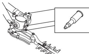
**REMARQUE!** L'engrenage ne doit pas être entièrement rempli de lubrifiant. Le lubrifiant se dilate sous l'effet de la chaleur qui se dégage lors du fonctionnement de la machine. Si l'engrenage est entièrement rempli de lubrifiant, les joints d'étanchéité risquent d'être endommagés, entraînant des fuites de lubrifiant.
