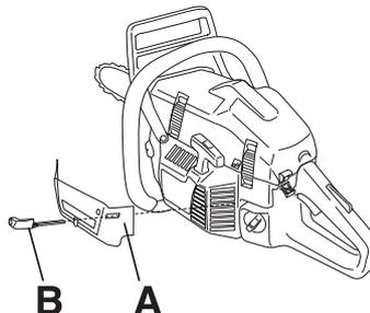
Ces dispositifs permettent de réduire la quantité d'air froid admise et empêchent que de grandes quantités de neige soient aspirées dans le compartiment du carburateur.
