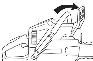
**Allumage; starter:** Mettre la commande de starter sur la position de starter. Le contacteur d'arrêt doit alors se placer automatiquement en position de démarrage.
