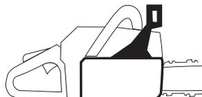
Observer la plus grande prudence en utilisant la tronçonneuse et s'assurer que la zone de rebond du guide-chaîne ne touche rien.
