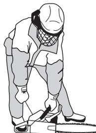
Enfoncer la commande de starter dès que le moteur s'emballe et répéter les lancements jusqu'au démarrage. Dès que le moteur démarre, appuyer et relâcher immédiatement la commande d'accélération. Ceci libère la gâchette d'accélération.
