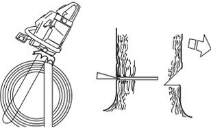
Der Fällschnitt soll parallel zur Kerbschnittlinie abschließen, so dass der Abstand zwischen beiden Schnitten mindestens 1/10 des Stammdurchmessers beträgt. Der nicht durchgesägte Teil des Stamm wird als Brechmaß bezeichnet.
