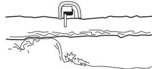
Zuerst von unten sägen (etwa 1/3 des Stammdurchmessers).
