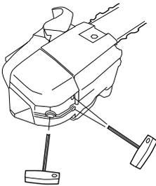
Bestimmte Schalldämpfer sind mit einem speziellen Funkenfangnetz ausgerüstet. Ist Ihr Gerät mit einem derartigen Schalldämpfer ausgestattet, so ist das Netz einmal wöchentlich zu säubern. Dies geschieht am besten mit einer Stahlbürste. Bei Verstopfung des Netzes läuft der Motor heiß, was schwere Motorschäden zur Folge haben kann.
