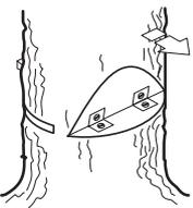
Man verliert völlig die Kontrolle über die Fallrichtung des Baumes, wenn das Brechmaß zu klein oder durchgesägt ist oder wenn Kerb- und Fällschnitt an falscher Stelle ausgeführt wurden.
