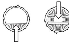
**Der Stamm wird an beiden Enden gestützt.** Es besteht große Gefahr, dass die Sägekette eingeklemmt wird.
