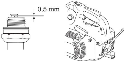
Hinweis! Stets den vom Hersteller empfohlenen Zündkerzentyp verwenden! Eine ungeeignete Zündkerze kann Kolben und Zylinder zerstören. Dafür sorgen, dass die Zündkerze eine sog. Funkentstörung hat.
