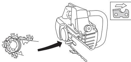
Darauf achten, dass die Schneiden der Sägezähne auf der Schienenoberseite nach vorn gerichtet sind.
