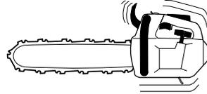
Kontrollieren, ob die Antivibrationselemente zwischen Motoreinheit und Handgriffeinheit fest verankert sind.
