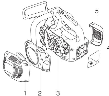
Das Kühlsystem einmal pro Woche mit einer Bürste reinigen, bei schwierigen Verhältnissen öfter. Eine Verschmutzung oder Verstopfung des Kühlsystems führt zur Überhitzung des Gerätes, die Schäden an Zylinder und Kolben zur Folge haben kann.
