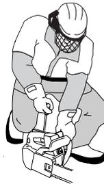
Sobald der Motor zündet, den Chokehebel einschieben und neue Startversuche machen, bis der Motor anspringt. Wenn der Motor anspringt, schnell Vollgas geben, und das Startgas schaltet sich automatisch aus.
