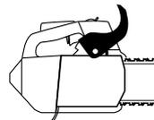
Vorsichtig arbeiten und dafür sorgen, dass der Rückschlagbereich der Führungsschiene nicht mit einem Gegenstand in Berührung kommt.
