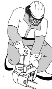
Halten Sie die Motorsäge mit festem Griff, in dem Sie die Handgriffe fest mit Daumen und Fingern umschließen.
