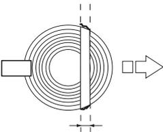
Das Brechmaß funktioniert wie ein Scharnier, das die Richtung des fallenden Baumstammes bestimmt.
