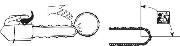
Das Sägen mit der Unterseite der Führungsschiene, d.h. von der Oberseite des Baumstammes nach unten, wird als Sägen mit ziehender Kette bezeichnet. Die Motorsäge wird zum Baumstamm hingezogen und die Vorderkante des Motorsägenkörpers fungiert als natürliche Stütze am Stamm. Beim Sägen mit ziehender Kette hat der Anwender eine bessere Kontrolle über die Motorsäge und über den Rückschlagbereich der Führungsschiene.
