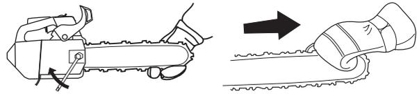
Die Spannschraube der Sägekette befindet sich bei unseren Motorsägenmodellen an unterschiedlichen Positionen. Siehe die Anweisungen unter der Überschrift Was ist was? bezüglich der Position der Spannschraube an Ihrem Modell.
