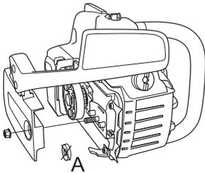
Die Schiene über die Schienenbolzen montieren. Die Schiene in der hintersten Position aufsetzen. Die Kette um das Kettenantriebsrad und in die Schienennut legen. Auf der Oberseite der Schiene beginnen.
