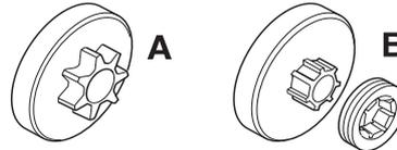
Regelmäßig den Verschleiß des Kettenantriebsrades kontrollieren. Austauschen, wenn das Rad unnormal verschlissen ist. Das Kettenantriebsrad bei jedem Wechsel der Sägekette austauschen.
