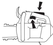
**Hinweis!** Die Kettenbremse rückerstellen, indem der Handschutz zum Handgriffbügel geführt wird. Damit ist die Motorsäge bereit zur Anwendung.
