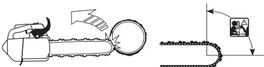
Ein Rückschlag ist immer in Richtung der Führungsschiene gerichtet. Am häufigsten erfolgt der Stoß von Motorsäge und Führungsschiene nach oben und nach hinten zum Anwender. Rückschläge erfolgen aber auch in andere Richtungen, je nachdem in welcher Stellung sich die Motorsäge in dem Augenblick befindet, in dem der Rückschlagbereich mit einem Gegenstand in Berührung kommt.
