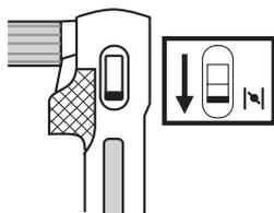
**Kraftstoffpumpe:** Mehrmals auf die Gummiblase der Kraftstoffpumpe drücken, bis diese sich mit Kraftstoff zu füllen beginnt. Die Blase braucht nicht ganz gefüllt zu werden.
