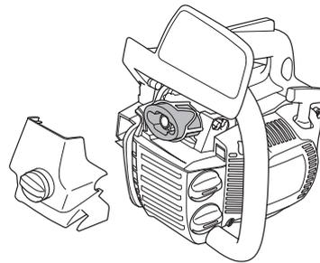
Eine gründlichere Reinigung erfolgt durch Auswaschen des Filters in Seifenwasser.
