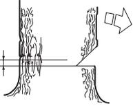
Die Rindenstütze (falls montiert) hinter dem Brechmaß ansetzen. Mit Vollgas sägen und mit der Sägekette/Führungsschiene langsam in den Baumstamm schneiden. Aufpassen, ob sich der Baumstamm entgegengesetzt zur Fällrichtung bewegt. Einen Fällkeil oder einen Fällheber in den Fällschnitt schieben, sobald die Schnitttiefe dies gestattet.
