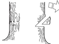
Die Schnitttiefe der Kerbe soll etwa 1/4 des Stammdurchmessers und der Winkel zwischen dem oberen und unteren Schnitt mindestens 45° betragen.
