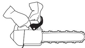
Geben Sie Vollgas und betätigen Sie die Kettenbremse, in dem Sie das linke Handgelenk gegen den Handschutz drehen. Lassen Sie den vorderen Handgriff nicht los. **Die Kette soll sofort stoppen.**
