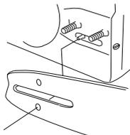
Die Kette durch Drehen der Kettenspannschraube im Uhrzeigersinn (einen Kombischlüssel verwenden) spannen. Die Kette soll gespannt werden, bis sie auf der Schienenunterseite nicht mehr durchhängt. Siehe die Anweisungen unter der Überschrift Spannen der Sägekette.
