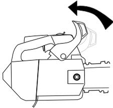
Die Schienenmutter herauserschrauben und den Kupplungsdeckel (Kettenbremse) abnehmen. Den Transportschutz (A) entfernen.
