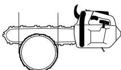
Il existe des méthodes d'abattage spécifiques pour les troncs dont le diamètre est supérieur à la longueur du guide-chaîne. Ces méthodes comportent un risque important de choc entre la zone de rebond du guide-chaîne et un objet.
