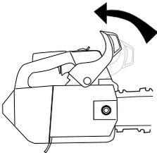
Dévisser l'écrou du guide-chaîne et retirer le carter d'embrayage (frein de chaîne). Déposer la protection de transport (A).
