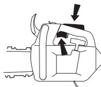
Remarque! Réinitialiser le frein de chaîne en poussant la protection anti-rebond contre l'étrier de la poignée. La tronçonneuse est maintenant prête à être utilisée.
