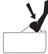
Actionner l'arceau d'avant en arrière pour s'assurer qu'il se meut librement et qu'il est solidement fixé à son articulation dans le carter d'embrayage.
