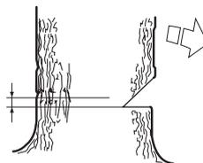
Placer le patin d'ébranchage (s'il y en a un de monté) derrière la charnière. Scier à plein régime et enfoncer graduellement le guide-chaîne dans le tronc. Attention si l'arbre se déplace dans le sens opposé au sens de chute choisi. Introduire un coin ou un bras de levier dans le trait de chute dès que la profondeur de coupe le permet.
