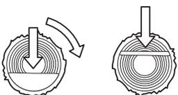
**Une extrémité du tronc repose sur un support.** Risque important de fendage.
