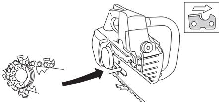
S'assurer que la face tranchante des dents est vers l'avant sur le dessus du guide.
