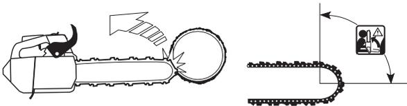
Le rebond se produit toujours dans le plan du guide-chaîne. En général, tronçonneuse et guide-chaîne sont relevés simultanément en direction de l'utilisateur. Néanmoins, la direction du rebond peut varier suivant la position de la tronçonneuse au moment où la zone de rebond du guide-chaîne touche un objet quelconque.
