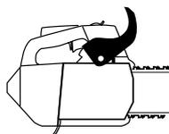
Observer la plus grande prudence en utilisant la tronçonneuse et s'assurer que la zone de rebond du guide-chaîne ne touche rien.
