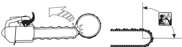
Le tronçonnage avec la partie inférieure de la chaîne, c'est à dire par dessus (de haut en bas), s'appelle méthode "poussée". La tronçonneuse est attirée vers l'arbre et le bord avant de la tronçonneuse devient un appui naturel contre l'arbre. Dans ce cas, l'utilisateur contrôle mieux à la fois sa tronçonneuse et la zone de rebond du nez.
