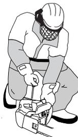
Enfoncer la commande du starter dès que le moteur s'allume et répéter les lancements jusqu'au démarrage. Quand le moteur démarre, accélérer rapidement à fond, ce qui en même temps supprime le ralenti accéléré.
