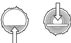
**Les deux extrémités du tronc reposent sur des supports.** Risque important de coinçage de la chaîne.
