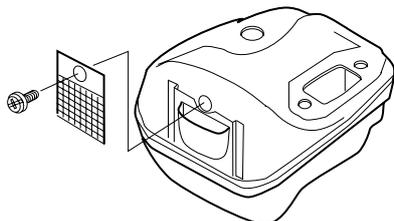
Le silencieux est conçu pour atténuer le bruit et dévier le flux des gaz d'échappement loin de l'utilisateur. Ces gaz sont chauds et peuvent transporter des étincelles risquant de causer un incendie si elles entrent en contact avec un matériau sec et inflammable.
