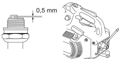
Remarque! Toujours utiliser le type de bougie recommandé! Une bougie incorrecte peut endommager le piston/le cylindre. S'assurer que la bougie est dotée d'un antiparasites.
