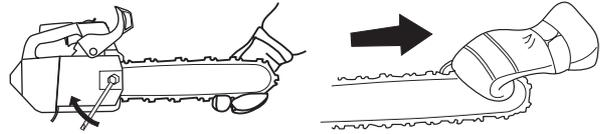
L'emplacement de la vis du tendeur de chaîne varie avec les modèles de tronçonneuses. Voir le chapitre Quels sont les composants? pour savoir où elle se trouve sur votre modèle.
