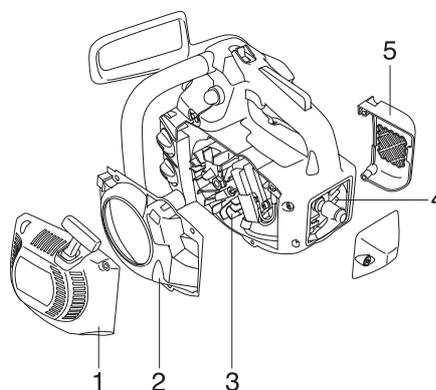
Nettoyer le système de refroidissement avec une brosse une fois par semaine, voire plus souvent dans des conditions difficiles. Un système de refroidissement sale ou colmaté provoque la surchauffe de la machine, endommageant le cylindre et le piston.
