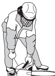
Den vorderen Griff mit der linken Hand umfassen. Mit dem rechten Fuß in den hinteren Griff treten und die Motorsäge gegen den Boden drücken. Den Startgriff mit der rechten Hand fassen und das Startseil bis zum ersten Widerstand (die Starterklinken rasten ein) langsam herausziehen, danach das Seil schnell und kraftvoll herausziehen. **Das Startseil niemals um die Hand wickeln.**
