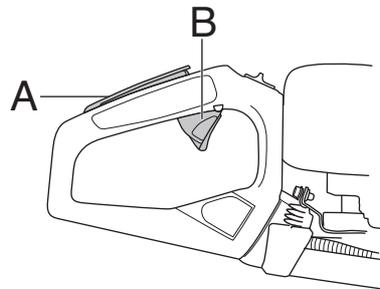
Kontrollieren, ob der Gashebel in Leerlaufstellung gesichert ist, wenn sich die Gashebelsperre in Ausgangsstellung befindet.
