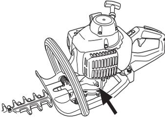
**ACHTUNG!** Das Getriebe darf nicht ganz mit Fett gefüllt werden. Das Fett dehnt sich durch die beim Betrieb des Gerätes entstehende Wärme aus. Ist das Getriebe ganz voll Fett, besteht die Gefahr, dass Dichtungen zerstört werden und Fett austritt.
