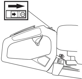
Den Motor starten und kontrollieren, ob der Motor stoppt, wenn der Stopschalter in Stopstellung geführt wird.
