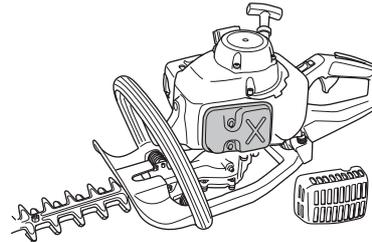
Bestimmte Schalldämpfer sind mit einem speziellen Funkenfangnetz ausgerüstet. Ist Ihr Gerät mit einem derartigen Schalldämpfer ausgestattet, so ist das Netz einmal wöchentlich zu säubern. Dies geschieht am besten mit einer Stahlbürste.
