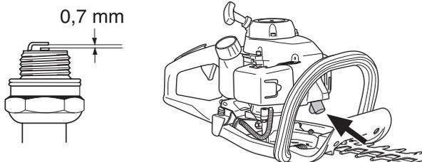
**ACHTUNG!** Stets den vom Hersteller empfohlenen Zündkerzentyp verwenden! Eine ungeeignete Zündkerze kann Kolben und Zylinder zerstören. Dafür sorgen, dass die Zündkerze eine sog. Funkentstörung hat.
