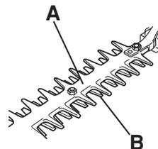
Den Messerschutz auf Beschädigungen und Deformationen kontrollieren. Den Messerschutz austauschen, wenn er verbogen oder beschädigt ist.
