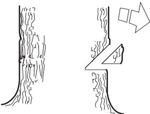
Die Schnitttiefe der Kerbe soll etwa  $\frac{1}{4}$  des Stammdurchmessers und der Winkel zwischen dem oberen und unteren Schnitt mindestens  $45^\circ$  betragen.
