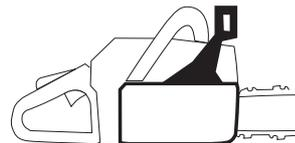
Vorsichtig arbeiten und dafür sorgen, dass der Rückschlagbereich der Führungsschiene nicht mit einem Gegenstand in Berührung kommt.
