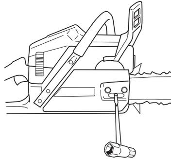
Die Kette ist richtig gespannt, wenn sie an der Schienenunterseite nicht durchhängt und noch leicht von Hand durchgezogen werden kann. Die Schienenspitze anheben und dabei gleichzeitig die Schienenmutter mit dem Kombischlüssel festschrauben.
