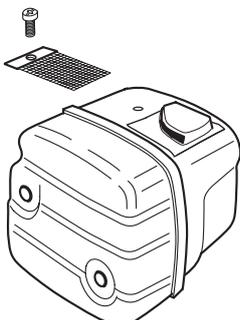
Der Schalldämpfer hat die Aufgabe, den Schallpegel zu dämpfen und die Abgase vom Anwender wegzuleiten. Die Abgase sind heiß und können Funken enthalten, die einen Brand verursachen können, wenn die Abgase auf trockenes und brennbares Material gerichtet werden.
