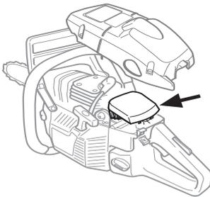
Eine gründlichere Reinigung erfolgt durch Auswaschen des Filters in Seifenwasser.
