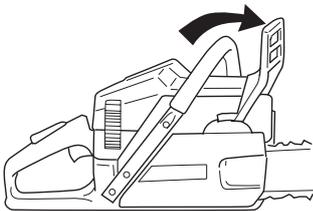
**Zündanlage; Choke:** Choker in Chokestellung bringen. Der Stoppschalter muss dabei automatisch in Startstellung wechseln.
