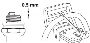
Hinweis! Stets den vom Hersteller empfohlenen Zündkerzentyp verwenden! Eine ungeeignete Zündkerze kann Kolben und Zylinder zerstören. Dafür sorgen, dass die Zündkerze eine sog. Funkenstörung hat.
