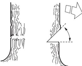
Der Schnittpunkt der beiden Schnitte wird als Kerbschnittlinie bezeichnet. Die Kerbschnittlinie soll exakt horizontal verlaufen und gleichzeitig einen rechten Winkel ( $90^\circ$ ) zur Fallrichtung bilden.
