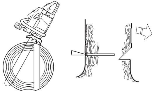
Der Fällschnitt soll parallel zur Kerbschnittlinie abschließen, so dass der Abstand zwischen beiden Schnitten mindestens  $\frac{1}{10}$  des Stammdurchmessers beträgt. Der nicht durchgesägte Teil des Stamm wird als Brechmaß bezeichnet.
