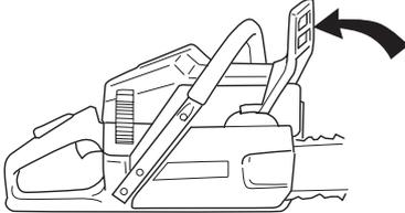
Die Schienenmutter lösen und den Kupplungsdeckel (Kettenbremse) abnehmen. Den Transportschutz (A) entfernen.
