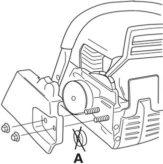
Die Schiene über die Schienenbolzen montieren. Die Schiene in der hintersten Position aufsetzen. Die Kette um das Kettenantriebsrad und in die Schienennut legen. Auf der Oberseite der Schiene beginnen.
