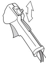
Kontrollieren, ob Gashebel und Gashebelsperre mit dem dazugehörigen Rückzugfedersystem leicht funktionieren.
