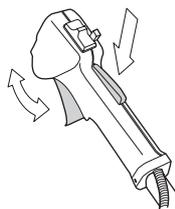
Voir le chapitre Démarrage. Démarrer la machine et donner les pleins gaz. Relâcher l'accélérateur et s'assurer que l'équipement de coupe s'arrête et qu'il reste immobile. Si l'équipement de coupe tourne lorsque l'accélérateur est au régime de ralenti, contrôler le réglage du ralenti du carburateur. Voir le chapitre Entretien.
