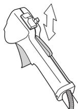
Vérifier que le blocage de l'accélération, la commande d'accélération et leurs ressorts de rappel fonctionnent correctement.
