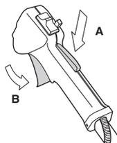
Vérifier d'abord que la commande de l'accélération est bloquée en position de ralenti quand le blocage de l'accélération est en position initiale.
