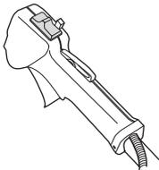
Mettre le moteur en marche et s'assurer qu'il s'arrête lorsque le bouton d'arrêt est amené en position d'arrêt.
