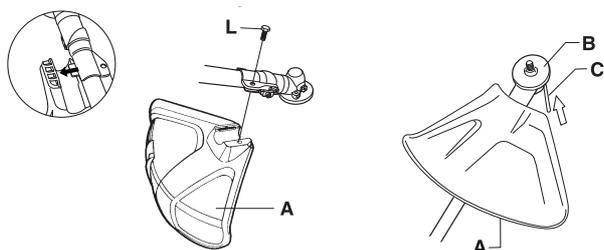
**142R:** Monter la protection (A) sur le carter moteur avec la languette (M) et les deux vis (L). REMARQUE! Veiller à ce que le bouclier de protection soit monté.
