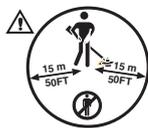
Les machines équipées d'une lame d'éclaircissage ou à herbe peuvent être projetées violemment sur le côté quand la lame rencontre un objet dur. La lame peut sectionner les bras et les jambes. Toujours maintenir les personnes et les animaux à au moins 15 mètres de la machine.
