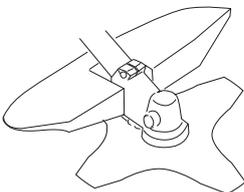
S'assurer que la protection est intacte et qu'elle ne présente pas de fissures. Remplacer la protection si elle a subi des coups ou si elle présente des fissures.
