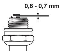
**REMARQUE!** Toujours utiliser le type de bougie recommandé! Une bougie incorrecte peut endommager le piston/le cylindre. S'assurer que la bougie est dotée d'un antiparasites.
