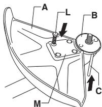
**133R:** Emboîter le carter de protection/la protection combinée dans la fixation du tube de transmission et fixer à l'aide d'une vis (L).
