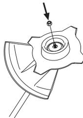
Pose: serrer l'écrou dans le sens contraire de la rotation de l'équipement de coupe. Dépose: desserrer l'écrou dans le sens de la rotation de l'équipement de coupe. (NOTA! L'écrou est fileté à gauche.) Serrer l'écrou à l'aide de la clé pour l'écrou de lame.
