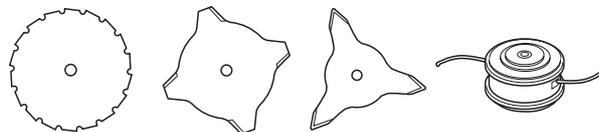
Maintenir les dents de la lame correctement affûtées! Suivre nos instructions et utiliser le calibre d'affûtage recommandé. Une lame mal affûtée ou endommagée augmente les risques d'accident.
