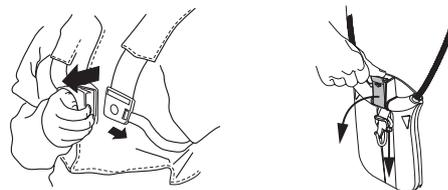
S'assurer du bon positionnement des bretelles du harnais. Quand le harnais et la machine sont ajustés, contrôler le bon fonctionnement du dispositif de libération rapide du harnais.
