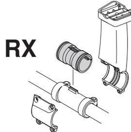
Vérifier que les éléments anti-vibrations sont entiers et solidement fixés.
