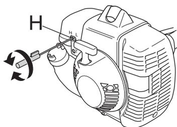
Noter que le moteur doit être mis sous charge lors du réglage du pointeau de haut régime H. Monter donc la tête de désherbage T35 (lanceur de 2,7 mm) avant de procéder au réglage du pointeau de haut régime. La longueur du lanceur doit être standard, c'est-à-dire jusqu'au couteau du carter de protection.
