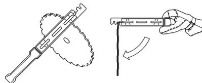
Inspecter l'équipement de coupe afin de détecter d'éventuels dommages ou fissures. Toujours remplacer un équipement de coupe endommagé.
