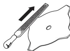
Maintenir un avoyage correct de la lame d'éclaircissage! Suivre nos instructions et utiliser le gabarit d'affûtage recommandé. Une lame d'éclaircissage mal affûtée augmente le risque de blocage et de rebond ainsi que d'endommagement de la lame.
