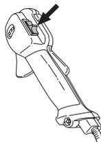
**REMARQUE!** L'interrupteur d'arrêt se remet automatiquement en position de démarrage. Toujours retirer le chapeau de bougie de la bougie lors du montage, contrôle et/ou entretien, afin d'éviter tout démarrage accidentel.
