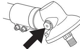
En général, il n'est pas nécessaire de remplacer le lubrifiant du carter, sauf en cas de réparations.
