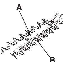
Patikrinkite, ar peilio apsauga nepažeista ir nedeformuota.
