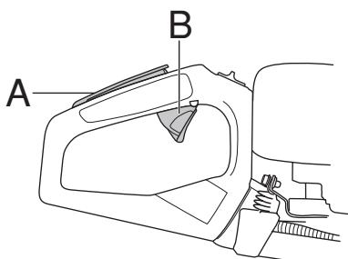
Patikrinkite, ar laisvoje eigoje akseleratorius yra užblokuotas, o akseleratoriaus gaiduko blokatorius yra savo pirminėje padėtyje.
