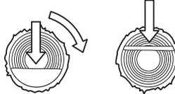
**Der Stamm wird an einem Ende gestützt.** Es besteht große Gefahr, dass er bricht.
