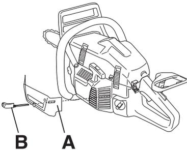
Diese vermindern die Kühlluft und verhindern das Einsaugen größerer Schneemengen in den Vergaserraum.
