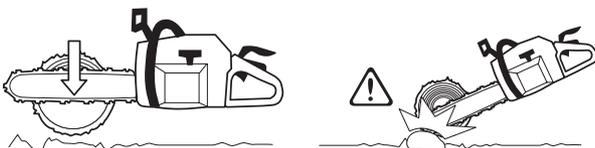
Wenn die Möglichkeit vorhanden ist (= kann der Stamm gedreht werden?), sollte der Stamm zu 2/3 durchgesägt werden.
