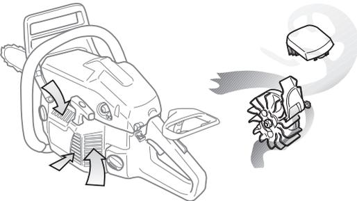
**WICHTIG!** Um die Funktion der Zentrifugalreinigung aufrecht zu erhalten, muss diese regelmäßig gewartet und gepflegt werden. Den Lufteinlass der Startvorrichtung, die Gebläseflügel des Schwungrads, den Raum um das Schwungrad, das Ansaugrohr und den Vergaserraum reinigen.
