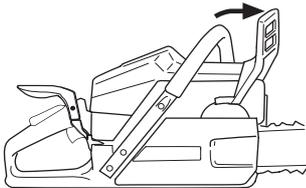
**Zündanlage; Choke:** Choker in Chokestellung bringen. Der Stoppschalter muss dabei automatisch in Startstellung wechseln.
