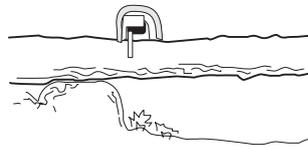
Zuerst von unten sägen (etwa 1/3 des Stammdurchmessers).
