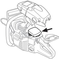
Eine gründlichere Reinigung erfolgt durch Auswaschen des Filters in Seifenwasser.
