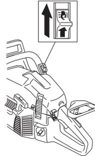
Wird der Schalter nach oben geschoben, schaltet sich die Heizung ein. Wird der Schalter nach unten geschoben, geht die Heizung aus.
