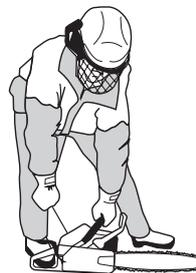
Sobald der Motor zündet, den Chokehebel einschieben und neue Startversuche machen, bis der Motor anspringt. Wenn der Motor anspringt, schnell Vollgas geben, und das Startgas schaltet sich automatisch aus.
