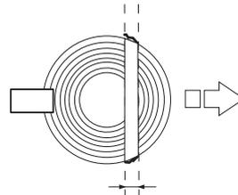
Das Brechmaß funktioniert wie ein Scharnier, das die Richtung des fallenden Baumstamms bestimmt.
