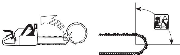
Ein Rückschlag ist immer in Richtung der Führungsschiene gerichtet. Am häufigsten erfolgt der Stoß von Motorsäge und Führungsschiene nach oben und nach hinten zum Anwender. Rückschläge erfolgen aber auch in andere Richtungen, je
