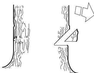
L'encoche doit faire 1/4 du diamètre du tronc et l'angle entre les deux entailles doit être d'au moins 45°.
