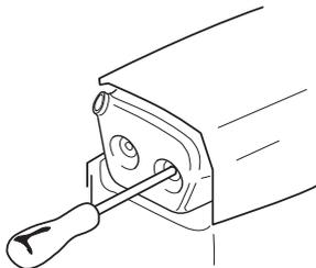
Certains silencieux sont munis d'une grille antiflamme. Cette grille doit être nettoyée une fois par semaine si la machine en est équipée. Utiliser de préférence une brosse en acier. Un pare-étincelles colmaté risque de causer la surchauffe du moteur et de provoquer de sérieuses avaries du moteur.
