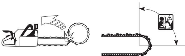
Le rebond se produit toujours dans le plan du guide-chaîne. En général, tronçonneuse et guide-chaîne sont relevés simultanément en direction de l'utilisateur. Néanmoins, la direction du rebond peut varier suivant la position de la tronçonneuse au moment où la zone de rebond du guide-chaîne touche un objet quelconque.
