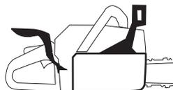
Observer la plus grande prudence en utilisant la tronçonneuse et s'assurer que la zone de rebond du guide-chaîne ne touche rien.
