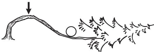
S'assurer de pouvoir agir sans risque et déterminer si une solution de toute sécurité est possible. En cas de difficulté, le plus sûr moyen est de ne pas se servir de la tronçonneuse et d'avoir recours à un treuil.
