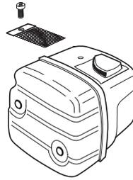
Le silencieux est conçu pour atténuer le bruit et dévier le flux des gaz d'échappement loin de l'utilisateur. Ces gaz sont chauds et peuvent transporter des étincelles risquant de causer un incendie si elles entrent en contact avec un matériau sec et inflammable.
