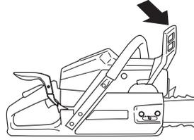
Actionner l'arceau d'avant en arrière pour s'assurer qu'il se meut librement et qu'il est solidement fixé à son articulation dans le carter d'embrayage.
