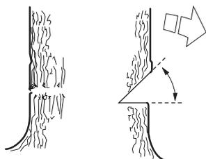
La ligne de jointure entre les deux entailles s'appelle le trait de chute. Le trait de chute doit être horizontal et former un angle de 90° avec le sens de chute prévu.
