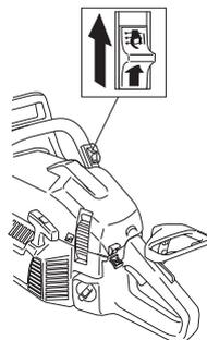
Pour mettre le chauffage, pousser le contact vers le haut. Pour couper le chauffage, pousser le contact vers le bas.
