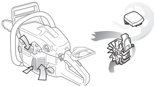
**IMPORTANT!** L'épuration centrifuge exige un entretien correct et continu de la machine. Nettoyer la prise d'air du lanceur, les ailettes du ventilateur, le compartiment du volant, le tuyau d'admission et le compartiment du carburateur.
