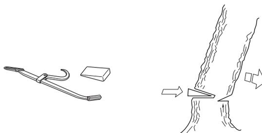
Nous recommandons une longueur de guide-chaîne supérieure au diamètre du tronc, pour que le trait de chute et l'encoche soient réalisés d'un simple trait de scie. Vous trouverez des informations sur les longueurs de guide-chaîne recommandées pour votre modèle de tronçonneuse au chapitre Caractéristiques techniques.
