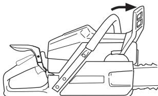
**Allumage; starter:** Mettre la commande de starter sur la position de starter. Le contacteur d'arrêt doit alors se placer automatiquement en position de démarrage.
