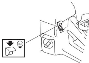
Le moteur est arrêté en poussant l'interrupteur d'arrêt en position d'arrêt.
