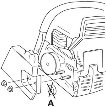
Positionner le guide-chaîne sur les écrous et l'amener à sa position la plus reculée. Placer la chaîne sur le pignon d'entraînement et dans la gorge du guide-chaîne. Commencer par le dessus du guide.
