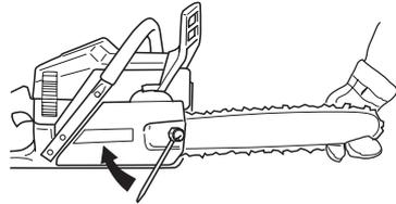
La tension d'une chaîne neuve doit être vérifiée fréquemment pendant son rodage. Vérifier régulièrement la tension. Une tension correcte est synonyme de bonne capacité de coupe et de longue durée de vie.
