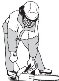
Enfoncer la commande du starter dès que le moteur s'allume et répéter les lancements jusqu'au démarrage. Quand le moteur démarre, accélérer rapidement à fond, ce qui en même temps supprime le ralenti accéléré.
