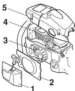
Nettoyer le système de refroidissement avec une brosse une fois par semaine, voire plus souvent dans des conditions difficiles. Un système de refroidissement sale ou colmaté provoque la surchauffe de la machine, endommageant le cylindre et le piston.
