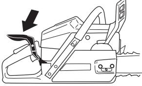
**Ne jamais porter ou suspendre la tronçonneuse par l'étrier! Ceci risque d'endommager le mécanisme et de mettre le frein de chaîne hors fonction.**
