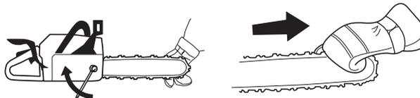
L'emplacement de la vis du tendeur de chaîne varie avec les modèles de tronçonneuses. Voir le chapitre Quels sont les composants? pour savoir où elle se trouve sur votre modèle.
