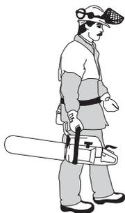
**Ne jamais porter ou suspendre la tronçonneuse par l'étrier! Ceci risque d'endommager le mécanisme et de mettre le frein de chaîne hors fonction.**
