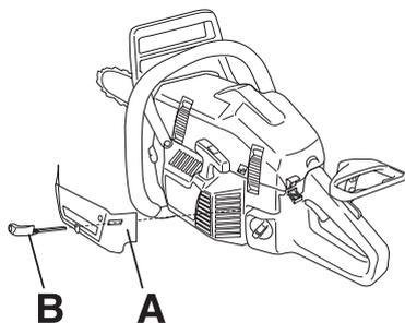
Ces dispositifs permettent de réduire la quantité d'air froid admise et empêchent que de grandes quantités de neige soient aspirées dans le compartiment du carburateur.
