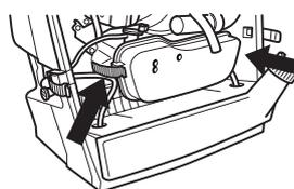
Le filtre à air est monté dans le carter de filtre à air.
