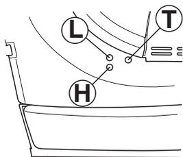
Les pointeaux L et H règlent le débit de carburant nécessaire par rapport au flux d'air permis par l'ouverture de la commande de l'accélération. S'ils sont tournés dans le sens des aiguilles d'une montre, le mélange est plus pauvre (moins d'essence); s'ils sont tournés dans le sens contraire des aiguilles d'une montre, le mélange est alors plus riche (plus d'essence). Un mélange pauvre donne un régime plus haut et un mélange riche donne un régime plus bas.
