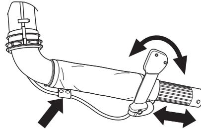
Connecter le tube intermédiaire et le tuyau d'échappement. Assembler le tube et le tuyau et les visser pour qu'ils se bloquent l'un dans l'autre.
