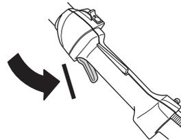
Appuyer sur le blocage de l'accélération et vérifier qu'il revient de lui-même en position initiale quand il est relâché.
