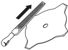
Inspecter l'équipement de coupe afin de détecter d'éventuels dommages ou fissures. Toujours remplacer un équipement de coupe endommagé.
