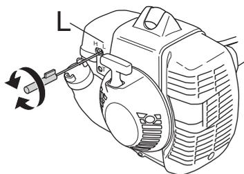
**REMARQUE!** Si l'équipement de coupe tourne au ralenti, tourner le pointeau de ralenti T dans le sens contraire des aiguilles jusqu'à l'arrêt de l'équipement de coupe.
