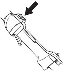
**REMARQUE!** L'interrupteur d'arrêt se remet automatiquement en position de démarrage. Toujours retirer le chapeau de bougie de la bougie lors du montage, contrôle et/ou entretien, afin d'éviter tout démarrage accidentel.
