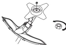
L'usure du verrouillage nylon du contre-écrou ne doit pas être telle qu'il peut se visser à l'aide des doigts. Le verrouillage doit résister à 1,5 Nm au moins. Remplacer le contre-écrou après une dizaine de serrages.
