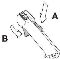
Vérifier d'abord que la commande de l'accélération est bloquée en position de ralenti quand le blocage de l'accélération est en position initiale.
