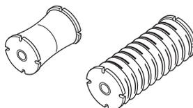
Vérifier régulièrement l'état des éléments afin de détecter fissures et déformations. Vérifier que les éléments anti-vibrations sont entiers et solidement fixés.
