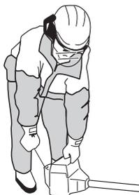
**REMARQUE!** Ne pas sortir complètement la corde du lanceur et ne pas lâcher la poignée avec la corde du lanceur complètement sortie. Cela pourrait endommager la machine.
