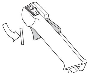
Appuyer sur le blocage de l'accélération et vérifier qu'il revient de lui-même en position initiale quand il est relâché.
