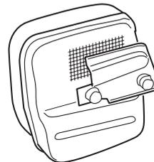
Sur les silencieux sans pot catalytique, la grille doit être nettoyée et si nécessaire remplacée une fois par semaine. Sur les machines dont le silencieux est muni d'un pot catalytique, la grille devra être inspectée et si nécessaire nettoyée une fois par mois. **Si la grille est abîmée, elle devra être remplacée.** Si la grille est souvent bouchée, ceci peut être dû à un mauvais fonctionnement du pot catalytique.
