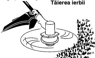
**SUFLARE** – Acțiunea de "ventilator" a firului care se rotește poate fi utilizată pentru a curăța rapid și ușor. Țineți firul paralel cu și deasupra suprafeței ce trebuie măturată și mișcați aparatul dintr-o parte în alta.
