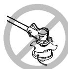
**⚠ ATENȚIE:** Lama continuă să se rotească după ce butonul de admisie este eliberat sau după ce motorul a fost oprit. Lama care merge în gol poate arunca obiecte sau poate tăia grav, dacă este atinsă din întâmplare. Opreți lama punând în contact partea dreaptă a lamei ce se mișcă în gol cu material deja tăiat.
