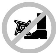
**⚠ ATENȚIE:** Inspectați zona unde ur-mează să lucrați înainte de a porni motorul. Înlăturați toate resturile și obiectele tarzi și ascuțite ca de ex. pietre, sticlă, sârmă etc., care pot ricoșa, pot fi aruncate sau pot cauza răniri în timpul funcționării aparatului.
