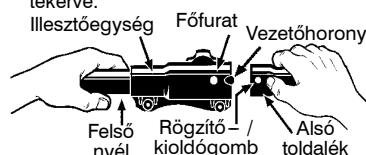
**FIGYELEM!** A gép használata előtt ellenőrizze, hogy a rögzítő- / kioldógomb rögzült-e a főfuratban, és a gombot szorosan meghúulta-e. minden toldaléket a főfurat segítségével kell csatlakoztatni, hacsak a megfelelő toldalék kezelési útmutatója másként nem rendelkezik. A rossz furat használata súlyos sérüléshez vagy a gép károsodásához vezethet.
