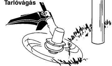
KASZÁLÁS – Kézi fünyírója ideálisan használható a hagyományos fünyírókkal hozzáérhetetlen helyeken. Kaszáláskor a damilit a talajjal párhuzamosan tartsa. A fejet ne nyomja bele a talajba, mivel így a földet gyalalja és tönkreteszi a gépet.
