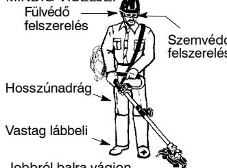
A gép üzemeltetésekor a vállszíjat kapcsolja rá a rögzítőelemre, álljon az ábrán látható módon és ügyeljen a következőkre:
