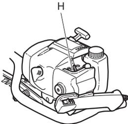
Vollgas geben und die Hochdrehzahldüse H sehr langsam im Uhrzeigersinn drehen, bis die Motorgeschwindigkeit abnimmt. Anschließend die Hochdrehzahldüse H sehr langsam gegen den Uhrzeigersinn drehen, bis der Motor ungleichmäßig läuft. Danach die Hochdrehzahldüse H langsam geringfügig im Uhrzeigersinn drehen, bis der Motor gleichmäßig läuft.
