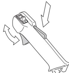
Siehe die Anweisungen unter der Überschrift Start. Die Heckenschere starten und Vollgas geben. Den Gashebel loslassen und kontrollieren, ob die Messer völlig zum Stillstand kommen. Wenn die Messer sich bewegen, während sich der Gashebel in Leerlaufstellung befindet, ist der Leerlauf des Vergasers einzustellen. Siehe die Anweisungen unter der Überschrift Wartung.
