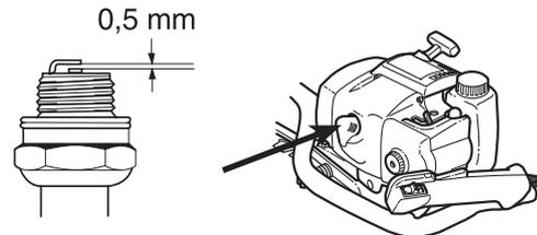
**ACHTUNG!** Stets den vom Hersteller empfohlenen Zündkerzentyp verwenden! Eine ungeeignete Zündkerze kann Kolben und Zylinder zerstören. Dafür sorgen, dass die Zündkerze eine sog. Funkenstörung hat.
