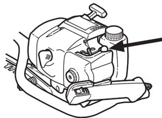
**Choke:** Den Chokehebel in Choke-Lage führen.
