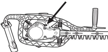
**ACHTUNG!** Das Getriebe darf nicht ganz mit Fett gefüllt werden. Das Fett dehnt sich durch die beim Betrieb des Gerätes entstehende Wärme aus. Ist das Getriebe ganz voll Fett, besteht die Gefahr, dass Dichtungen zerstört werden und Fett austritt.
