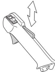
Kontrollieren, ob Gashebel und Gashebelsperre mit dem dazugehörigen Rückzugfedersystem leicht funktionieren.
