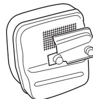
Bei Schalldämpfern ohne Katalysator sollte das Netz einmal in der Woche gereinigt und ggf. ausgetauscht werden. Bei Katalysatorschalldämpfern ist das Netz einmal im Monat zu kontrollieren und evtl. zu reinigen. **Beschädigte Netze sind auszutauschen.** Wenn das Netz häufig verstopft ist, kann dies ein Zeichen dafür sein, dass der Katalysator nicht einwandfrei arbeitet. Lassen Sie das Gerät bei Ihrem Fachhändler überprüfen. Wenn das Netz verstopft ist, wird
