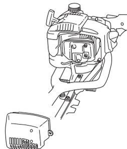
Bestimmte Schalldämpfer sind mit einem speziellen Funkenfangnetz ausgerüstet. Ist Ihr Gerät mit einem derartigen Schalldämpfer ausgestattet, so ist das Netz einmal wöchentlich zu säubern. Dies geschieht am besten mit einer Stahlbürste.
