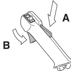
Kontrollieren, ob der Gashebel in Leerlaufstellung gesichert ist, wenn sich die Gashebelsperre in Ausgangsstellung befindet.
