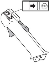
Mettre le moteur en marche et s'assurer qu'il s'arrête lorsque le bouton d'arrêt est amené en position d'arrêt.
