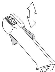
Vérifier que le blocage de l'accélération, la commande d'accélération et leurs ressorts de rappel fonctionnent correctement.
