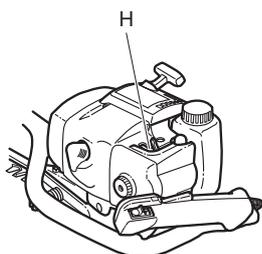
Donner les pleins gaz et tourner le pointeau haut-régime H très lentement dans le sens des aiguilles d'une montre jusqu'au ralentissement du moteur. Tourner ensuite le pointeau haut-régime H très lentement dans le sens inverse
