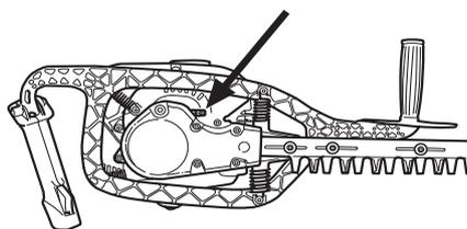
**REMARQUE!** L'engrenage ne doit pas être entièrement rempli de lubrifiant. Le lubrifiant se dilate sous l'effet de la chaleur qui se dégage lors du fonctionnement de la machine. Si l'engrenage est entièrement rempli de lubrifiant, les joints d'étanchéité risquent d'être endommagés, entraînant des fuites de lubrifiant.
