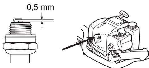
**REMARQUE!** Toujours utiliser le type de bougie recommandé! Une bougie incorrecte peut endommager le piston/le cylindre. S'assurer que la bougie est dotée d'un antiparasites.
